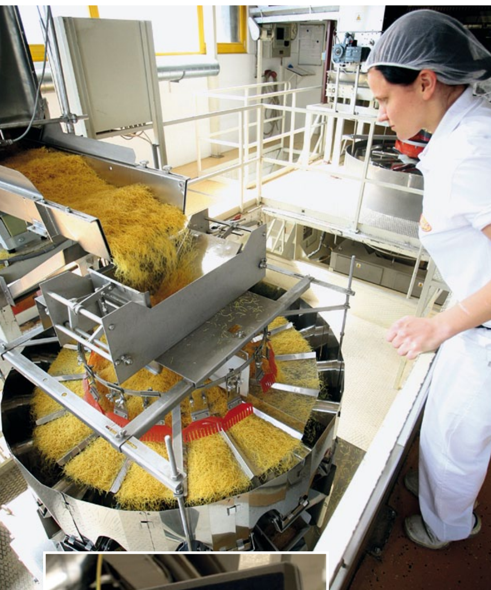
■ Abb. 1: Das Produkt, hier Fadennudeln, gelangt von oben auf die Verteilteller der Waagen.
