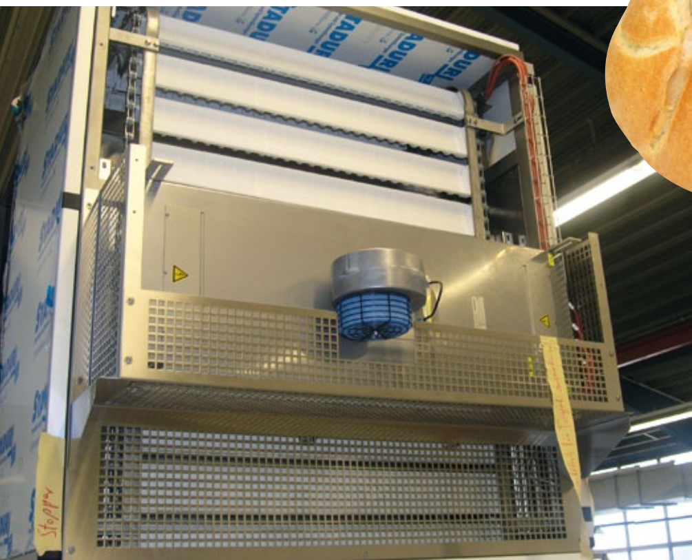
■ Abb. 1: WP Kemper bietet für Brötchenanlagen der Linie „Evolution“ nun die hocheffektive IR-Sterilisation.
