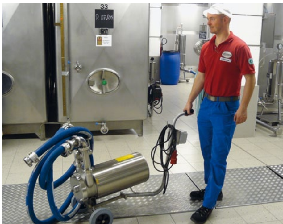
■ Abb. 3: Mobile Sipla-Pumpe zum Fördern von Grund- und Zusatzstoffen in der Getränkeproduktion.
