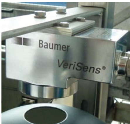
■ Abb. 2: Der Verisens Vision Sensor überwacht die aufgebrachten Platinen von oben. Eine externe DOM-Beleuchtung unterstützt die Auswertung der spiegelnden und unebenen Flächen der oberen Platinen.
