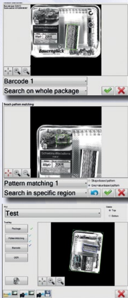
■ Abb.: Das Bizerba Vision System prüft Etiketten und Hinweistexte, Siegelnaht und Folienfarbe und klassifiziert Produkte nach deren Qualität.
