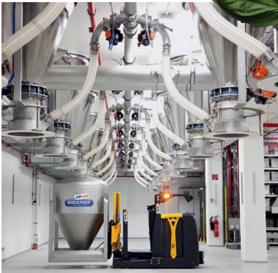
Abb. 1: Vollautomatisches Absammelsystem mittels Daxner Container Systems DCS in Verbindung mit FTS-System (Fahrerloses Transportsystem).
