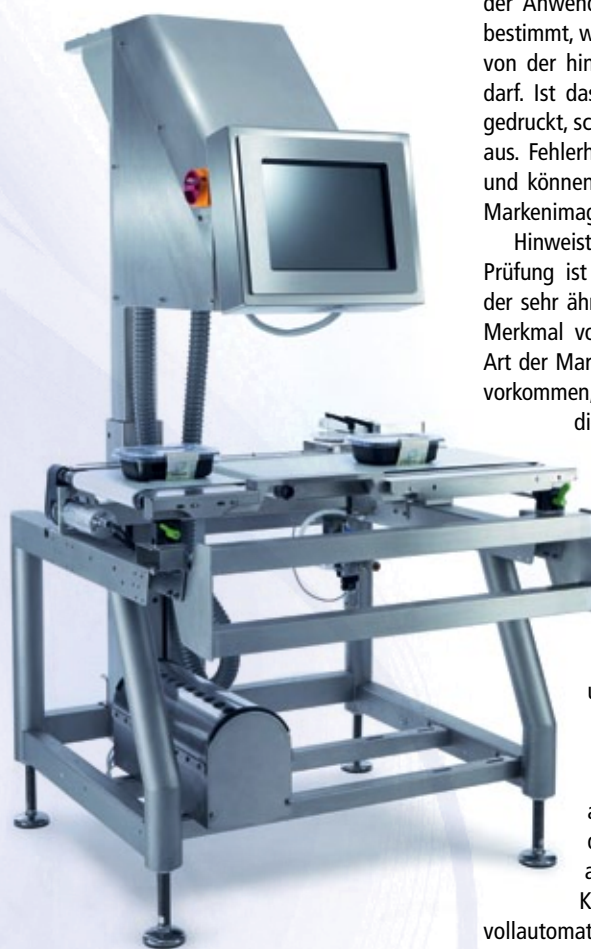
■ Abb.: Das Bizerba Vision System prüft Etiketten und Hinweistexte, Siegelnaht und Folienfarbe und klassifiziert Produkte nach deren Qualität.
