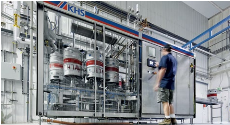
■ Abb. 2: Bei der Innokeg Till Combikeg handelt es sich um einen äußerst kompakt gestalteten Keg-Reiniger und -Füller im Containerformat, der nach dem bewährten und von KHS seit Jahrzehnten permanent weiterentwickelten Rundläuferprinzip arbeitet.
