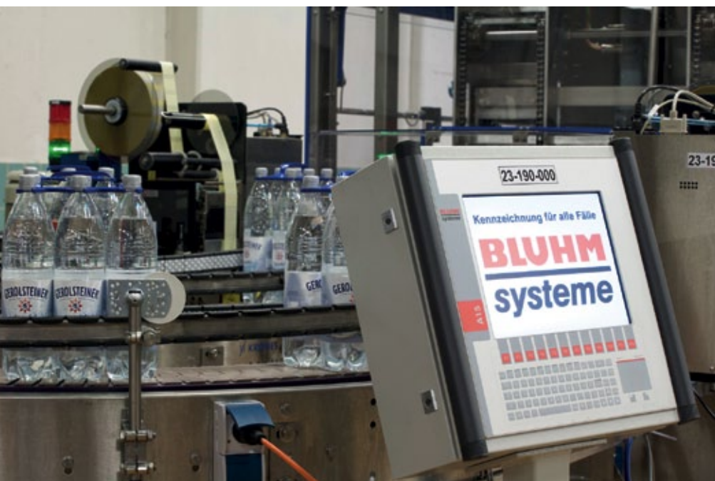
Abb. 1: Am Etikettendruckspender angeschlossenen Industrie-PC kann die benötigte Artikelnummer per Touchscreen einfach aufgerufen werden.
