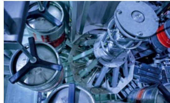
■ Abb. 4: Die Innokeg Till Combikeg vom Typ R 5 für die Left Hand Brauerei ist mit fünf Reinigungsköpfen und einem Füllkopf ausgestattet. Die Leistung der Maschine beträgt bis zu 70 Keg/h.
