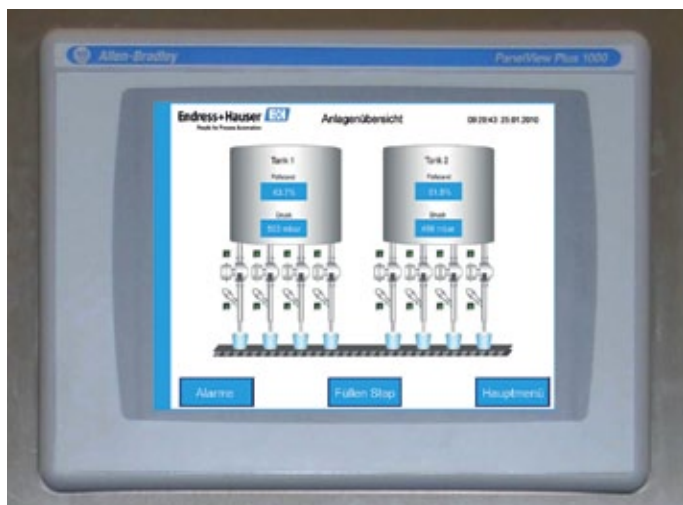
■ Abb. 2: Das 10,4" Touch-Panel stellt dem Maschinenbetreiber alle Freiheiten zur vor Ort Bedienung: Anlagenbild, Rezepturverwaltung, Benutzerverwaltung, Sprachumschaltung, spezielle Parameteranpassung zur Optimierung des Abfüllvorgangs.
