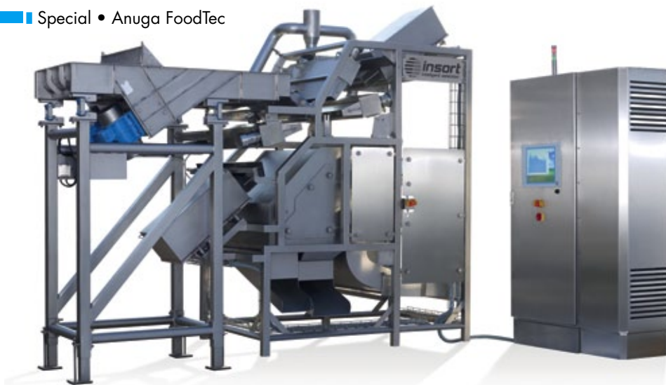
Abb. 3: Der Sherlock Separator verwendet ein neuartiges Verfahren der „Chemical Imaging Technology“ für Lebensmittel – eine fortschrittliche Technologie auf Basis der Nahinfrarot Spektroskopie. (© Insort)
