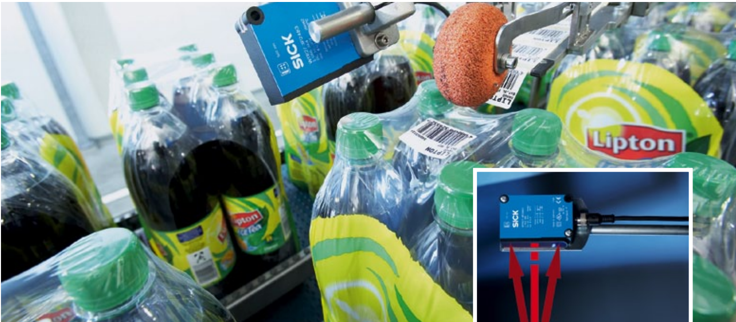
■ Abb. 2: Der Multipac-Sensor eignet sich ideal zur Erfassung jeder Art und Größe in PET-Folie verpackten oder damit umschumpften Gebinde.
