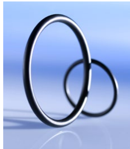
■ Abb. 2: Spezial EPDM Werkstoff AP 302 für die Lebensmittel-/Pharmaindustrie mit FDA und USP Class VI Zulassungen, geeignet bei CIP/SIP Prozessen und WFI tauglich. © C. Otto Gehrckens
