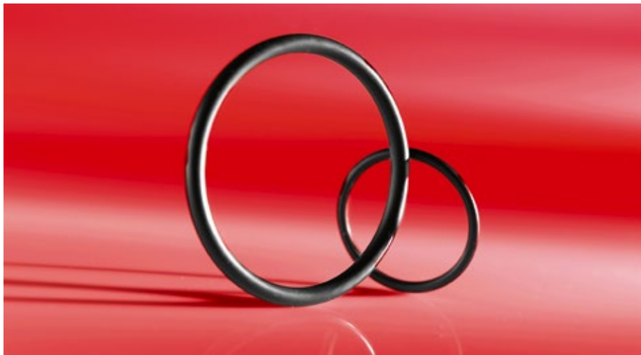
■ Abb. 1: Hochleistungs-FKM Vi 780 für die Lebensmittel- und Pharmaindustrie mit FDA und USP Class VI Zulassungen, geeignet bei CIP/SIP Prozessen und im Einsatz mit WFI – kann auch hervorragend in den engen Einbauräumen gemäß Hygienic Design verbaut werden.
