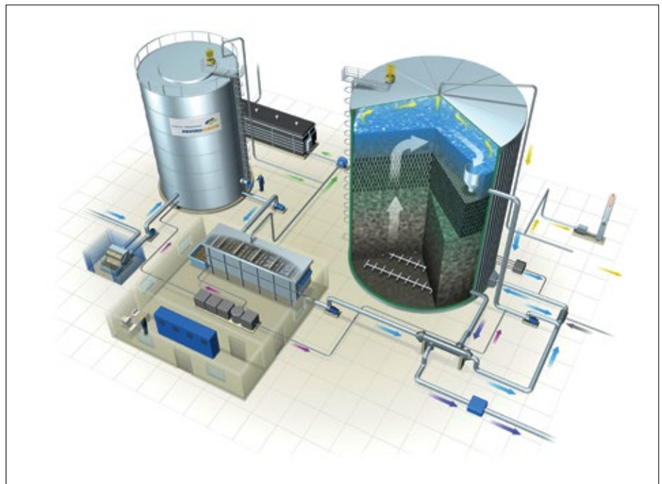
■ Abb. 3: Abwasserreinigungsanlage mit aerober und anaerober Reinigungsstufe.
