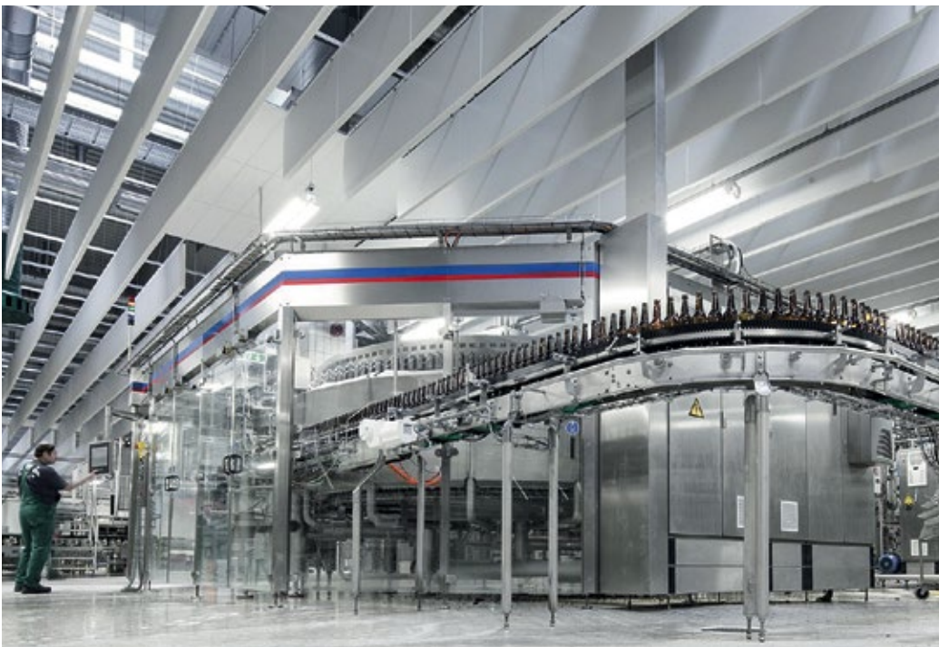
■ Abb. 2: Als eine der ersten Brauereien weltweit investierte die Wernesgrüner Brauerei in die neu entwickelte KHS-Füller-Baureihe Innofill Glass DRS-ZMS, die konsequent gemäß den Regeln des Hygienic Design konstruiert ist.
