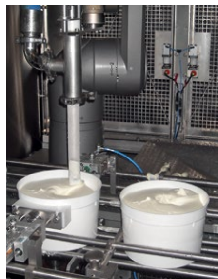
Abb. 2: Stäubli: Bei der Primärverpackung wie hier beim Abfüllen von Eiscreme sind strengste Hygienestandards einzuhalten. © Big Drum Engineering
