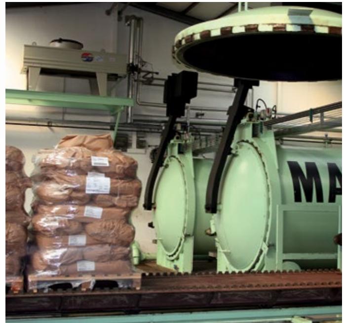
■ Abb. 3: Die Druckbehandlung mit CO 2 ist auch für Bio-Produkte zugelassen.
