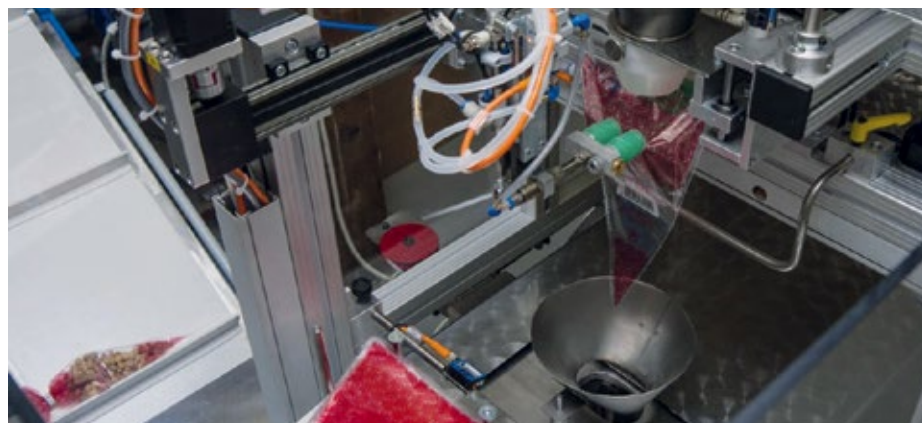
■ Abb. 2: Der Beutelwickler PR verarbeitet Blockbodenbeutel, Standbodenbeutel und Kreuzbodenbeutel. Dabei können die Maße individuell festgelegt werden.
