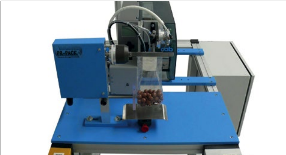
■ Abb. 3: Die Abfüllanlage für Spitz- und Blockbodenbeutel greift automatisch einzelne Beutel aus dem Vorrat und führt diese der Befüllstation unter der Waage zu. Ist der Befüllvorgang erfolgreich, wird der Beutel an die Verschlussstation weitergeleitet.
