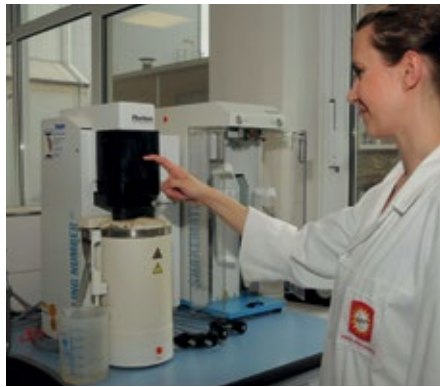
■ Abb. 2: Mit Erntebeginn werden Getreideproben in den unternehmenseigenen Mühlenlabors eingehend untersucht. Bei Weizen stehen insbesondere Parameter wie Protein- und Feuchtklebergehalt, Qualität des Klebers, Beschaffenheit der Stärke und enzymatischer Zustand im Fokus.
