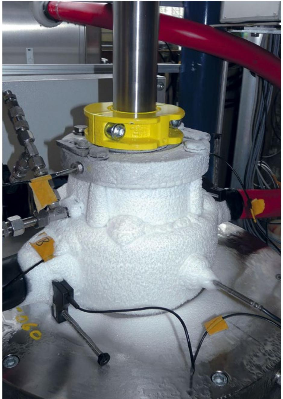
Abb.: Ekato Tieftemperatur-Gleitringdichtung auf dem Prüfstand
