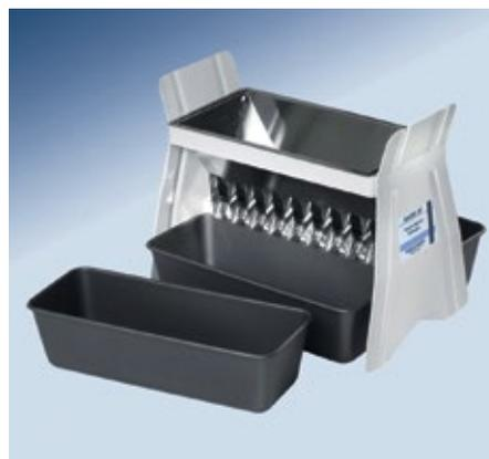
Abb. 2: Beim Riffelteiler wird die Ursprungsmenge durch Auslässe aufgeteilt, bis die zur Analyse erforderliche Menge erreicht ist..
