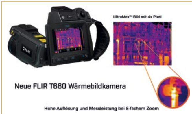
Die Ansicht und Bearbeitung der Bilder erfolgt über die FLIR Tools-Software für PCs. Die Bilder ermöglichen es den Anwendern, an kleinere Wärmeanomalien heranzuzoomen und präzisere Messungen sowie detailliertere Ansichten als mit den unbearbeiteten Bildern zu erhalten. Die neue T460 und T660 beinhalten neben all diesen Funktionen auch auf 1.500 °C bzw. 2.000 °C erwei-
