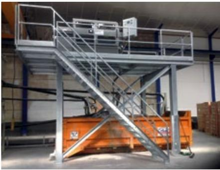
Abb. 2: Da die Automaten der AF-Serie nahezu beliebig oft entleert werden können, kann die Presse relativ klein gebaut werden. Bei gleichem Format braucht der Vollautomat von Aquachem nur etwa ein Sechstel der Fläche einer konventionellen Presse.
