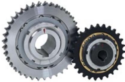
Die Sicherheitskupplung Typ ECH für Kettenantriebe von Enemac vereint die Vorteile der Kugelrastkupplungen mit der kurzen Bauform von Rutschkupplungen (Rutschnaben). Das Abtriebsselement in Form eines Kettenrades ist als Funktionsteil in die Kupplung integriert. Durch den Formschluss der Kupplung mittels Kugeln,
