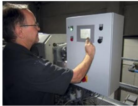
Abb. 3: Grundsätzlich kann über die Steuerung jede beliebige Kennlinie gefahren werden. Die Qualität des Kuchens kann dabei in Bezug auf Durchsatz, Ergebnis oder Verschleiß und Energieverbrauch optimiert werden.
