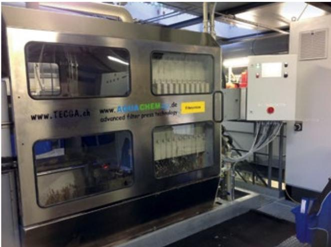
Abb. 1: Undichtigkeiten beim Plattenpaket können zum Austreten der Suspension führen. Nicht so bei den Vollautomaten von Aquachem. Diese arbeiten dank abgedichteter Filterplatten, einer SPS-Steuerung sowie weiterer verfahrenstechnischer Besonderheiten rund um die Uhr sauber und zuverlässig.
