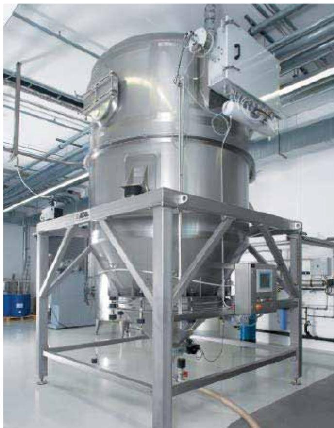
Förderwaage mit Ventilweiche für hohe Wiegegenauigkeiten auch bei großen Durchsatzmengen.
