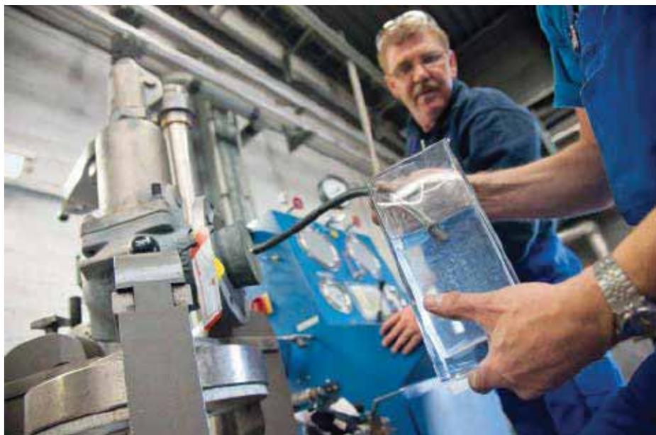
Abb. 3: Servicemitarbeiter prüfen mit Druckluft die Dichtheit eines Armaturensitzes.
