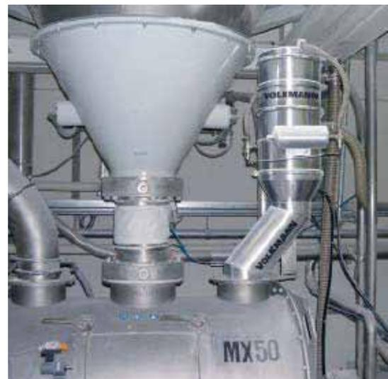
Abb. 2: Vakuumförderer (rechts im Bild) zur Beschickung eines Horizontalmischers mit verschiedenen Pulvern
