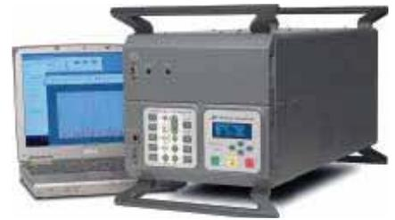
korrosive Gasen suchen. Das UGA enthält eine zweistufige Druckreduktionsstufe zur Abnahme von Proben bei Atmosphärendruck.
