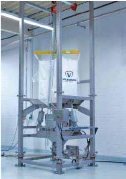
Abb. 4: Big-Bag Entleerstation: speziell ausgelegt, um das entleerte Material mit einem Vakuumförderer seinem Bestimmungsort zuzuführen
