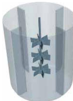
Abb. 2a: Geometrie des Rührkesselreaktors, in STAR-CCM+ modelliert
