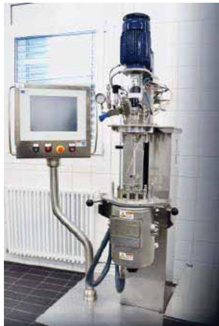
Abb. 1: Versuchsreaktor im Ekato-Technikum (ELA 5)
