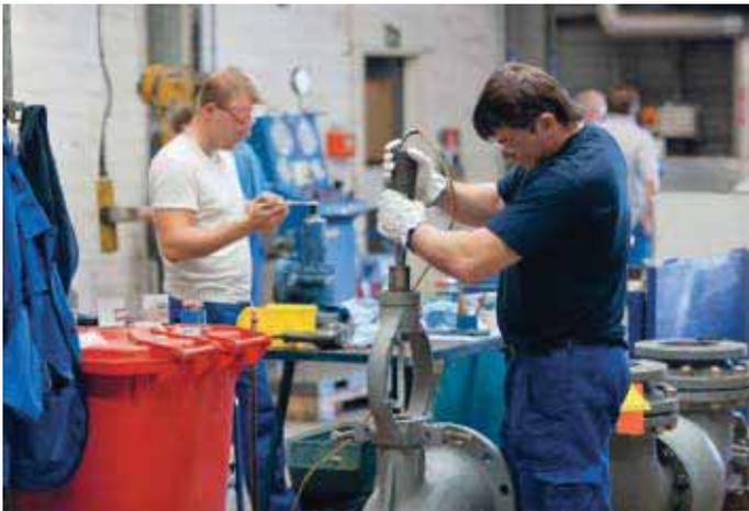
Abb. 4: Servicemitarbeiter schleift die Spindelführung eines Eckventils.
