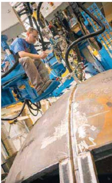
Abb. 2: Für einen Druckreaktor schweißt Kremsmüller Halbkugelböden automatisiert mit einer Fehlerquote von Null.
