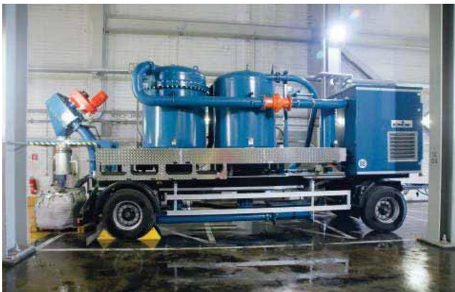
Abb.1: Einsatz einer Staubsauganlage mit aufgebautem Aerzener Drehkolbengebläse (rechts im schalldämmenden Gehäuse) in einer Werkshalle.
