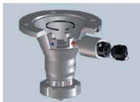
Abb. 3: Während sich die Pumpenwelle dreht, schalten vier Magnete nacheinander den Reed-Sensor.
