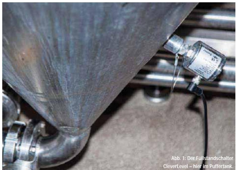
Abb. 1: Der Füllstandschalter CleverLevel – hier im Puffertank.
