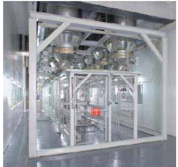
Der Azo Componenter dosiert und wiegt grammgenaue und vollautomatisch Additive und Zuschlagstoffe.
