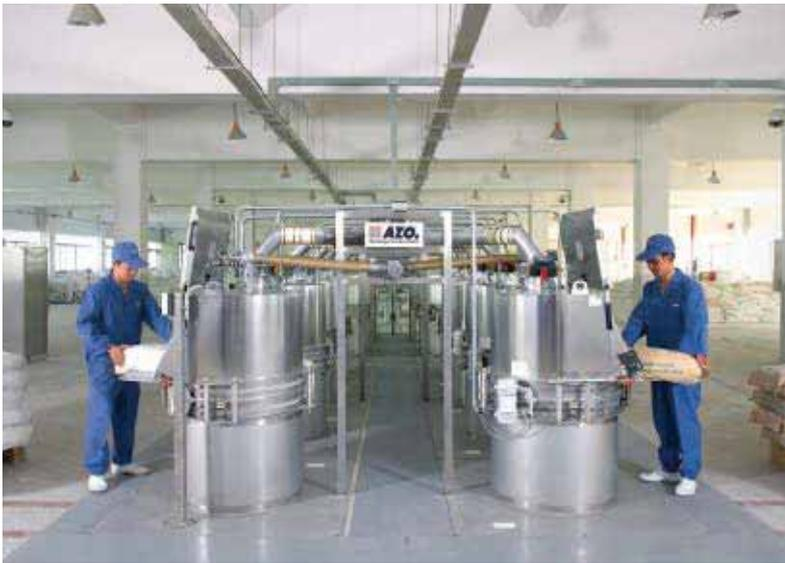
Zwei Reihen mit Einfülltrichtern über dem Componenter.
