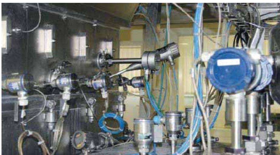
Abb. 3: Wird die Sonde inline eingesetzt, erfährt man durch die kontinuierliche Darstellung des Partikelgrößenverlaufs umgehend, wie der Prozess gerade läuft.
