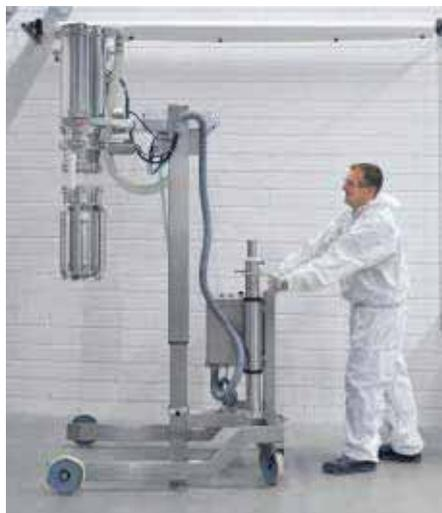
Abb. 3: Mobiler Einsatz: Vakuumförderer in höhenverstellbarem Fahrwagen für die Pulverversorgung an verschiedenen Stellen und einfache Entnahme zwecks nachfolgender Reinigung
