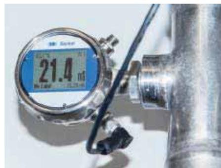
4: Das Leitfähigkeitsmessgerät CombiLyz in der CIP-Leitung sorgt für eine reibungslose Regelung des mehrstufigen CIP-Prozesses
