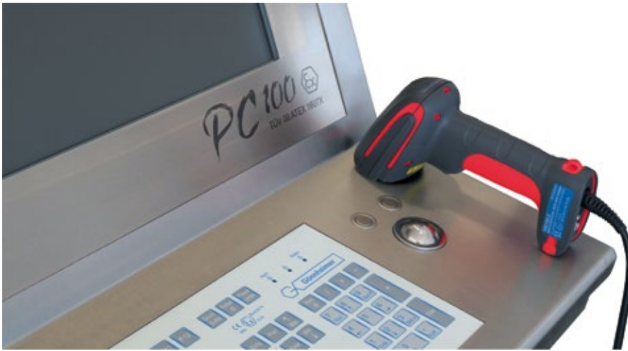
Abb. 1: Explosionsgeschützter 2D-Handscanner im Einsatz in der Ex-Zone 1 an einer mobilen PC100 Ex- Bedienstation
