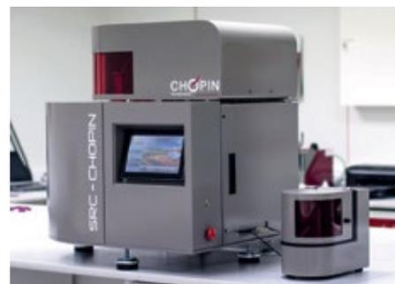
■ **Abb. 3:** Die SRC (Solvent Retention Capacity)-Methode ist eine Methode der Flüssigkeitszufuhr und beruht auf dem zunehmenden Quellvermögen der verschiedenen Polymere des Mehls.
