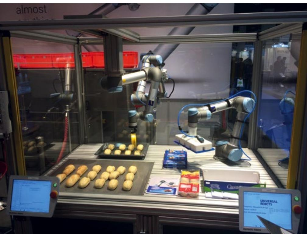
Abb. 1: Zwei UR5-Roboter auf der Anuga FoodTec 2015. Der linke Roboterarm zeigt eine Sprühanwendung. Auch das Bestreuen mit Körnern wäre denkbar. Rechts entnimmt der Roboter verpackte Brötchen einer Maschine und platziert sie an anderer Stelle. Je nach Gestaltung des Greifarms sind 10 bis 15 Platzierungen pro Minute möglich.
