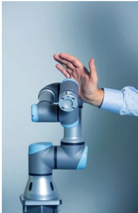
■ **Abb. 2: Der UR3 kann bereits bei einer Kraftauswirkung von gerade einmal 50 N stoppen.**
