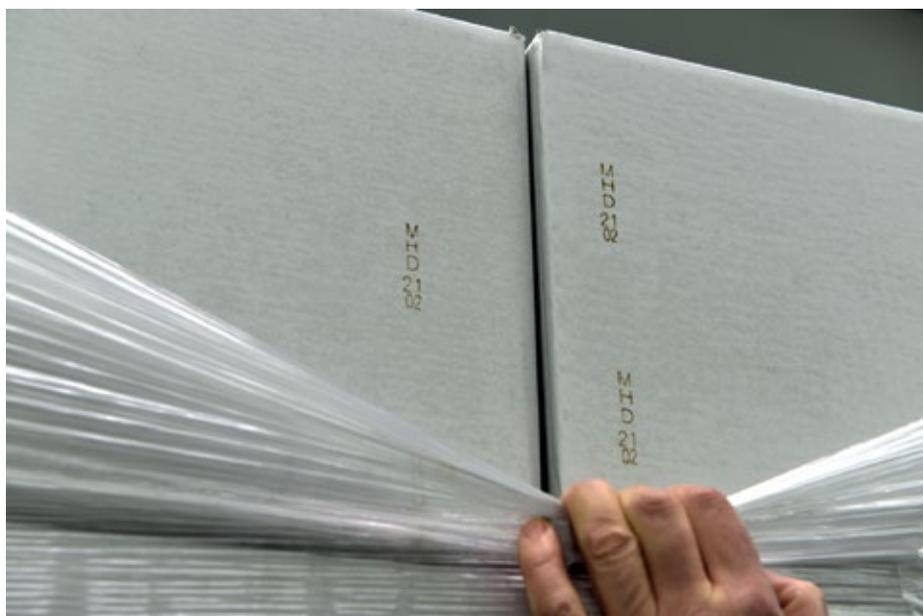
■ Abb. 3: Die bereits auf der Palette eingestreckten Packstücke werden nachträglich mit einem Laser durch die Stretchfolie hindurch beschrieben.
