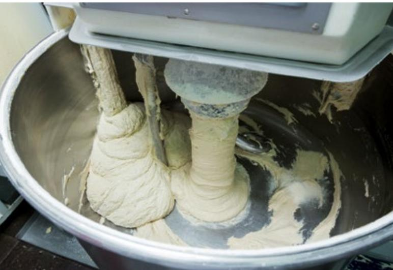
■ Abb. 1: Bei der Teigbereitung in Knetern sorgt die Beimischung von Flüssig-Stickstoff oder Flüssig-Kohlendioxid für gleichmäßige Temperaturverhältnisse.
