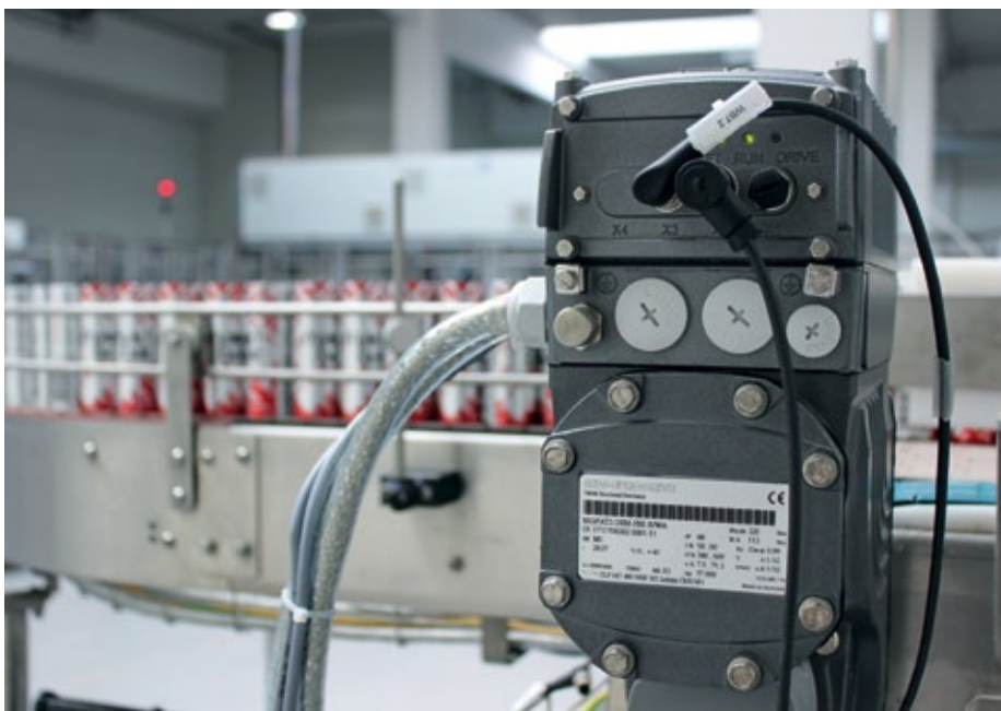
■ Abb. 3: Für den hygienischen und energieeffizienten Transport der Getränkeverpackungen kommt das mechatronische Antriebssystem Movigear von SEW-Eurodrive zum Einsatz.
