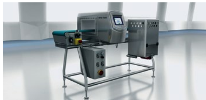
■ Abb. 2: Der Profi für Produkteffekte: Das Profile Advantage System steigert Erkennungsraten bei Molkerei- oder Fleischereiprodukten um bis zu 50 % Prozent und senkt Fehlausschleusungen um bis zu 95 %.
