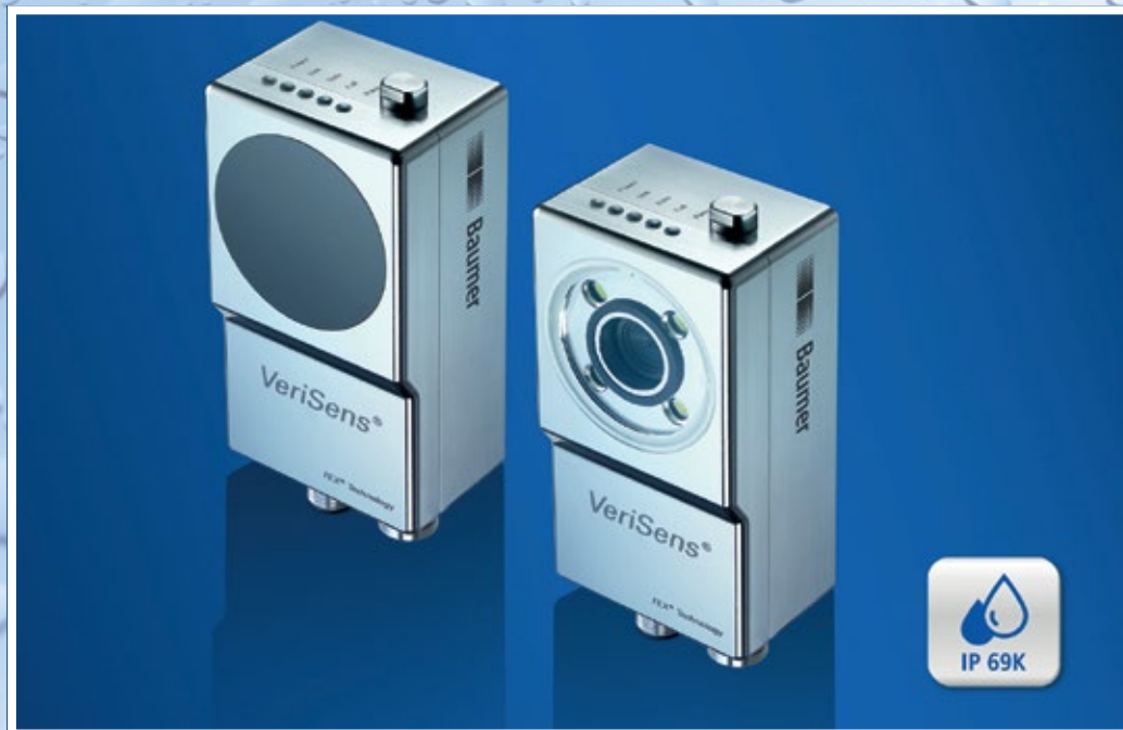
■ Abb. 1: Die Verisens Modelle der XF-Serie sind die einzigen Vision Sensoren am Markt im Washdown-Design mit Schutzart IP 69K (Edelstahl 1.4404, links mit Infrarotbeleuchtung und integriertem Tageslichtsperrfilter, rechts mit weißer LED-Beleuchtung).
