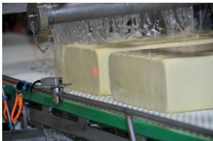
■ Abb. 2: Vor allem in den Bereichen der Salzbäder setzt die nasse und hoch salzhaltige Umgebung den Komponenten der Fördertechnik zu.
