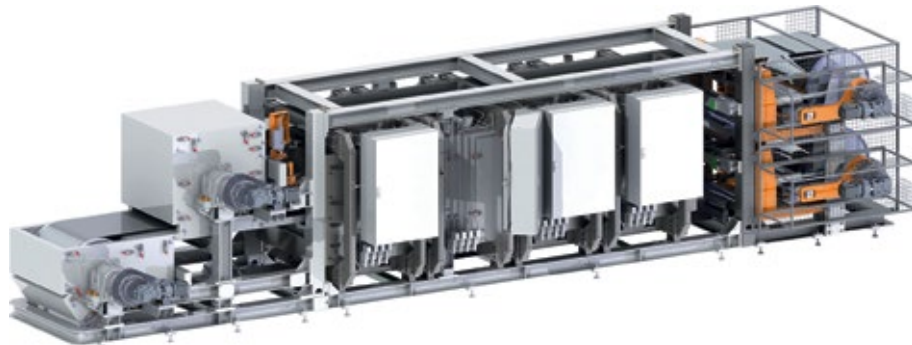
Die modular aufgebaute Doppelbandpresse für die Kunststoffindustrie, die damit Flacherzeugnisse wie Komposite (faserverstärkte Thermoplaste) noch effizienter in Endlosprozessen erzeugen kann.
