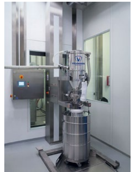
Abb. 6: Dosierte und verwogene Fass-Befüllung mittels Vakuumförderer (in Hubsäule montiert)
