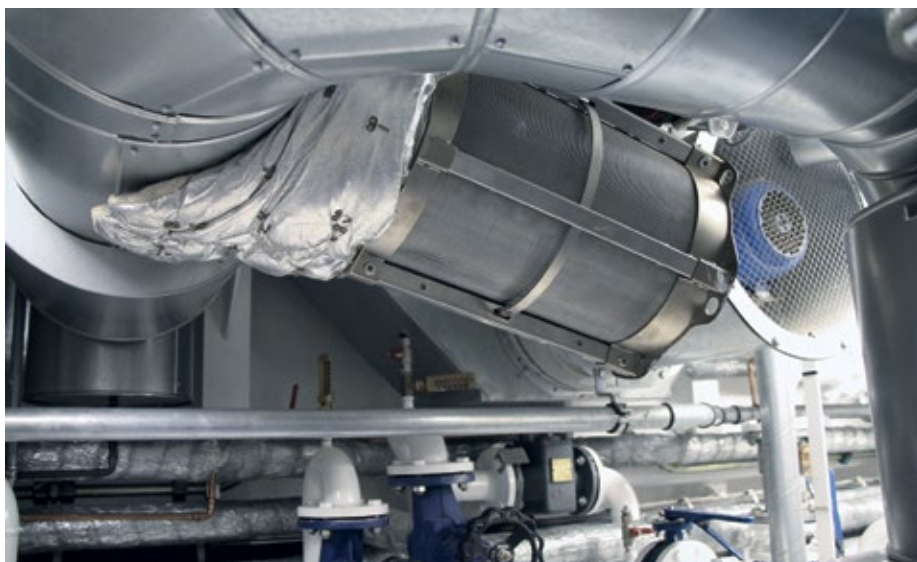
Abb. 3: Die MS Ostfriesland, eine deutsche Fähre, wird ausschließlich mit LNG (Liquefied Natural Gas) betrieben. Am Abgastrakt schützt ein Q-Rohr vor den Auswirkungen möglicher Explosionen.
