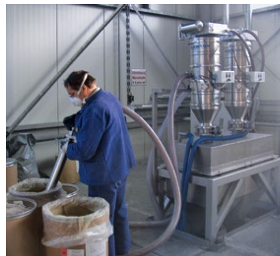
Abb. 3: Manuelle Absaugung von Pulvern aus Fässern mit Inliner (links) und Zuführung auf die Verpackungsanlage durch Vakuumförderer (rechts)
