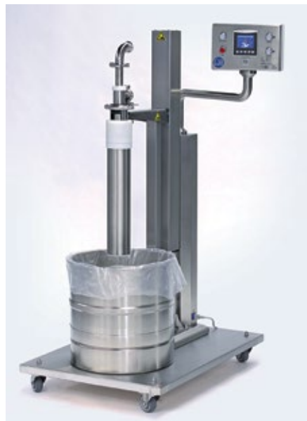
Abb. 5: Förderung von Schüttgütern aus Edelstahl-Fässern durch eine automatisch nachgeführte Absaugung von oben
