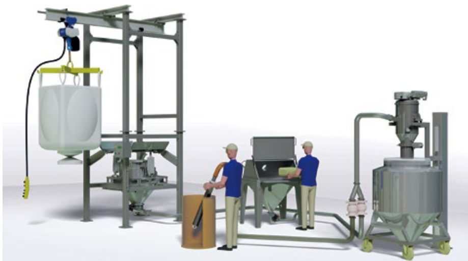
Abb. 2: Varianten der Gebinde-Entleerung mittels Vakuumförderung: Big-Bags, Säcke, Fässer und Beschickung eines Containers
