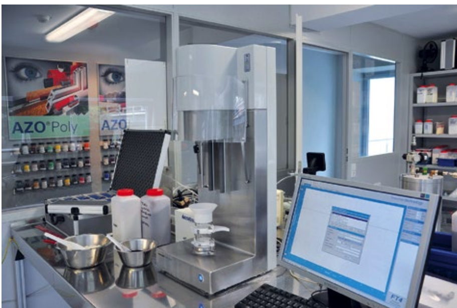
Abb. 1 Das FT4 Powder Rheometer bildet eine der Grundlagen für Pulvercharakterisierung bei AZO.
