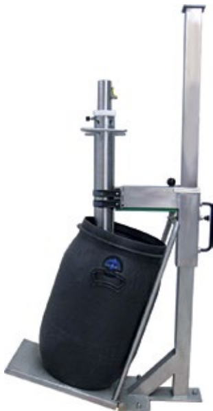
Abb. 4: Mit einer einfachen Kippvorrichtung wird das Fass zur Entleerung schräg gestellt
