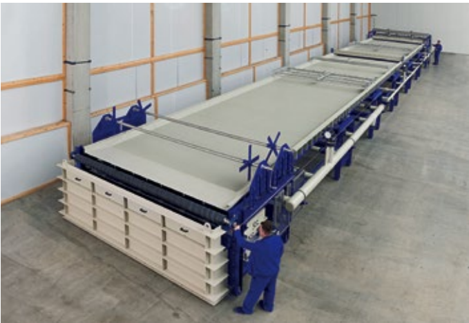
Abb. 1: Das BHS Taktbandfilter vom Typ BF 350-255 während der Endmontage Anfang 2016 im Werk Sonthofen.
