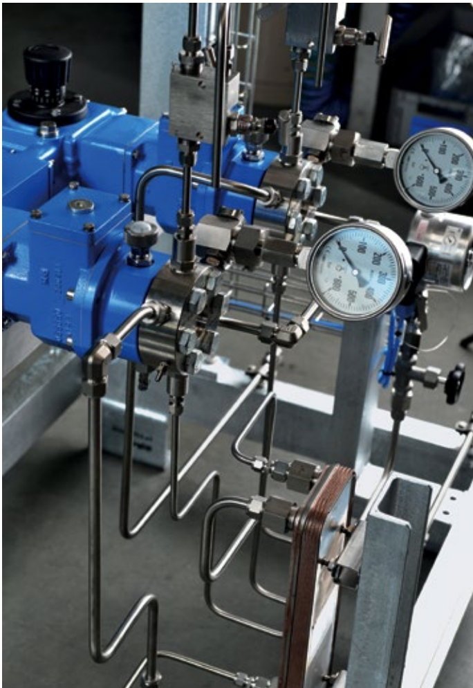
Abb. 1: Mit dem Lewa Ecofoam-System lassen sich Treibmittel wie CO 2 , Propan, Butan, halogenierter Kohlenwasserstoff und Pentan mengen genau in die Kunststoffschmelze eines Extrusionsprozesses eindosieren.
