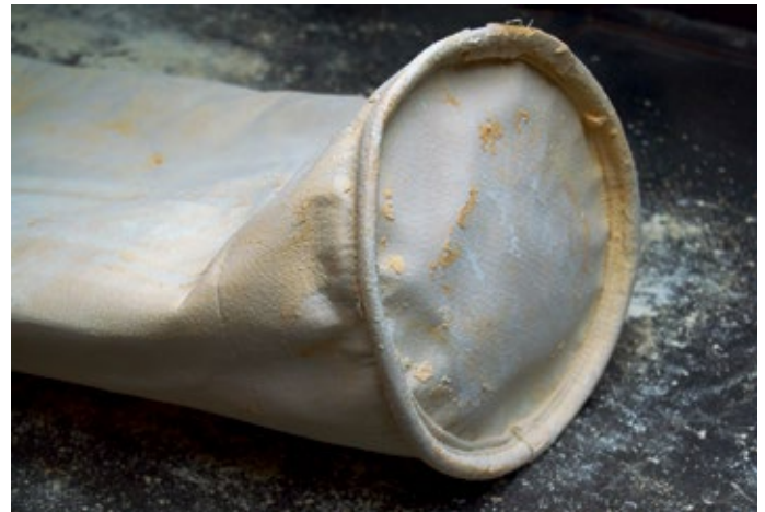
Abb. 3: Filterschlauch aus PPS nach 12 Monaten Standzeit in CIP-gereinigter Filteranlage
