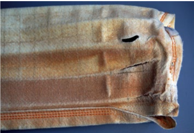
Abb. 2: Sekundär mechanisch beschädigter Filterschlauch nach chemischer Vorschädigung
