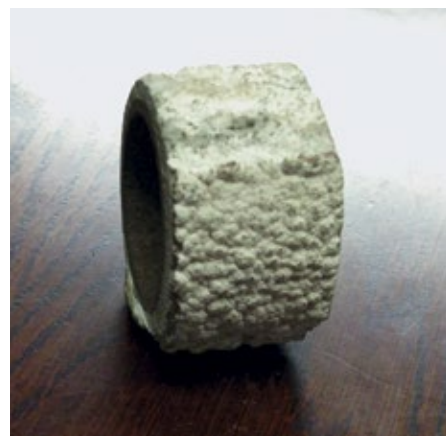
Abb. 3: Ausfällungen an einem Feuerrohr infolge schlechter Zusammensetzung des Speisewassers. In diesem extremen Fall musste der gesamte Kessel verschrottet werden.
