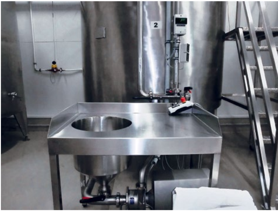
Abb. 1: Am Misch Tisch werden die Rezepturen zubereitet und von dort zum Homogenisieren in den Tank gepumpt.
