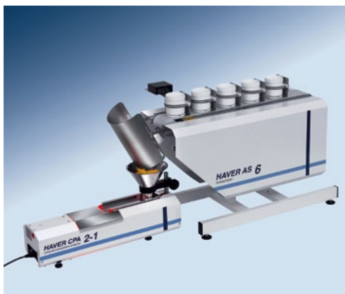
Abb. 3: Die Kombination der beiden Geräte eignet sich auch für die dynamische Bildanalyse.
