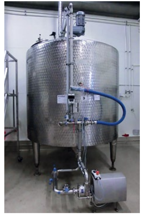
Abb. 2: Im Tank werden die Lösungen über etwa 1,5 Tage hinweg durch Umpumpen gemischt. In dieser Zeit steht die Pumpe ständig unter Druck.
