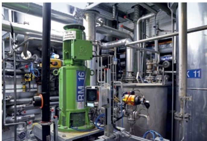
Abb. 1: Mehrproduktanlage für die Herstellung von organischen Peroxiden. Auf dem Reaktor der Conti-Anlage ist das Rührgerät (RM 16) angebracht. Rechts im Bild eine Destillationsanlage (K 11), in der ein Zwischenprodukt thermisch aufgetrennt wird.
