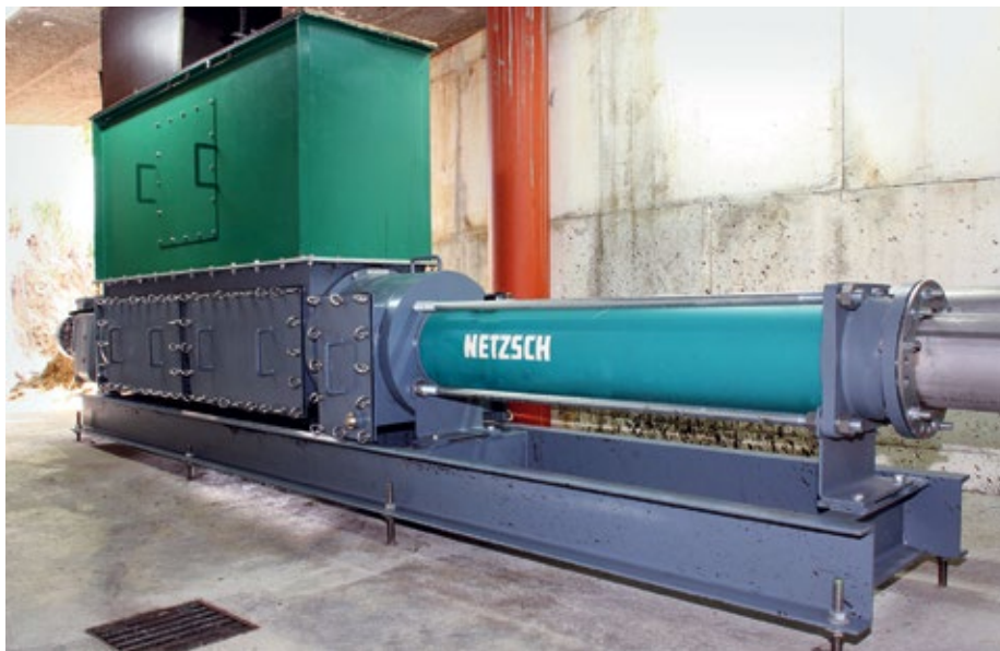
Abb. 2: Das bereits mit Gärbakterien geimpfte Gemisch wird von einem Rotor-Stator-System schonend weitertransportiert. In den in sich geschlossenen Förderkammern treten dabei weder Pulsation noch Scherkräfte auf, so dass die Mikroben nicht verletzt werden und sich die Mediumsphasen nicht trennen.
