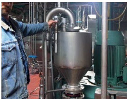
Abb. 2: Früher wurde in dem Unternehmen eine solche Füllstandmesssonde mit einem Schaltpunkt verwendet. Sie zeigte ausschließlich hohe Füllstände an.
