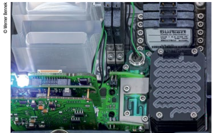
Abb. 5: Detail aus dem FIA-Modul: Fotometer und Mischer (rechte Bildhälfte)
