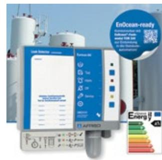
Tanks über eine Vakuumpumpe, die durch einen sparsamen Gleichstrommotor (Energieeffizienzklasse A++) angetrieben wird, einen Unterdruck und gibt bei einem Leck optisch und akustisch Alarm. Für die Montage im Freien ist das Gerät auch im Schutzgehäuse oder im Schutzgehäuse mit Heizung erhältlich.
