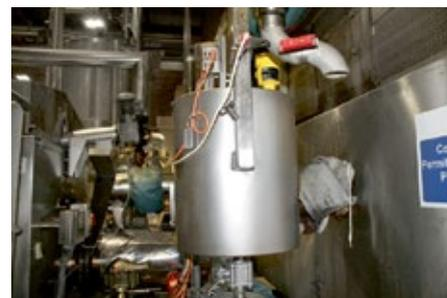
■ **Abb. 3:** Der britische Chips-Hersteller verbesserte die Produktqualität und produziert umweltschonender, denn die bessere Steuerung durch den Vegapuls 64 optimiert die Energie- und Ölzufuhr. Daher sollen alle Fritteusen künftig mit den 80-GHz-Radarsensoren ausgestattet werden.
