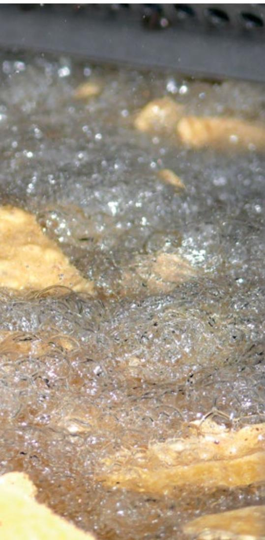
■ **Abb. 1:** Die Idealtemperatur der Tortilla-Chip-Fritteuse liegt bei 186 °C.
