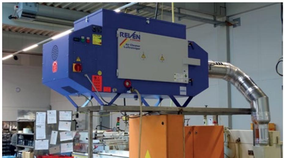
seitlich ausziehbar. Ein besonderer Trick verlängert die Standzeit des Abscheiders: Die aus der Maschine abgesaugte warme und ölhaltige Luft wird mit Raumluft angereichert und kühlt dadurch ab, ehe sie den Abscheider erreicht. Dadurch kondensiert vorab schon ein Teil der Emissionen und entlastet den nachfolgenden Reinigungsprozess. Diese Vorabscheidung ist laut Reven vor allem bei hoher Aerosolkon-
