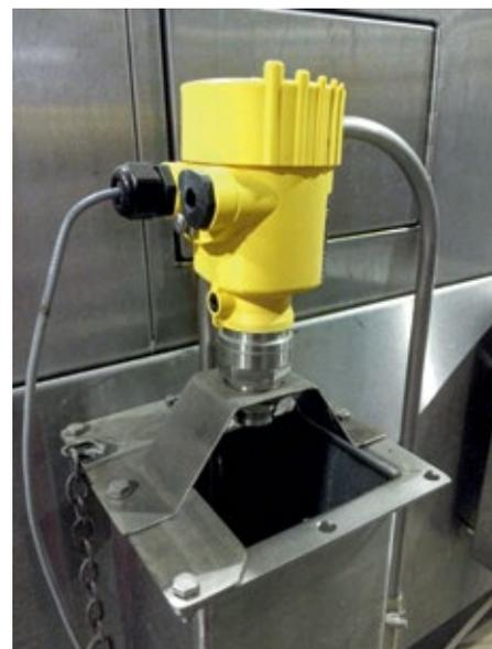
■ **Abb. 2:** Als Vega neue Anwendungen für die Prototypen des 80-GHz-Radarsensors für Flüssigkeiten suchte, war dies die ideale Testumgebung: Der installierte Vegapuls 64 Radarsensor erkannte den Füllstand des Öls millimetergenau ohne jegliche Auswirkungen durch dielektrische Veränderungen.
