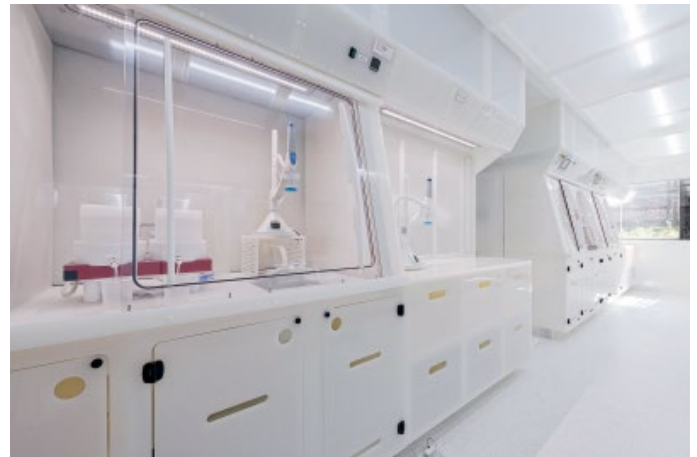
Abb. 2: Die fünf Arbeitsplätze sind absolut metallfrei und bieten Partikelfreiheit auf dem Niveau der Klassen 4 und 5 gemäß DIN EN ISO 14644.
