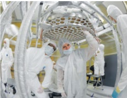
Abb. 3: Die Lichtsensoren vor dem Aufsetzen auf die Kammer.
