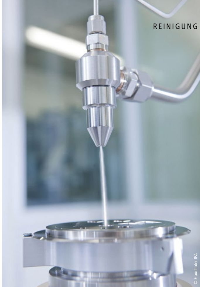
Abb. 1: In die Einhausung der Anlage sind Filtersysteme integriert, um die Reinigung unter Reinraumbedingungen durchführen zu können. © Lake Region Medical
