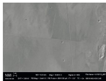
Die Probe nach der Reinigung mit dem acp-Schneestrahlsreinigungssystem. © NMI
