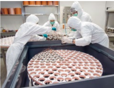
Abb. 2: Im Reinraum werden die Lichtsensoren in ihre Halterung eingesetzt.
