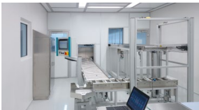
Abb. 2: Die gereinigten Teile werden durch eine Materialschleuse in einen Reinraum ausgegeben. © UCM
