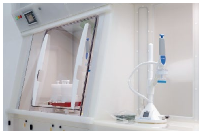
Abb. 4: Auf eine Einfärbung der Kunststoffe wurde weitgehend verzichtet; die in den Farben enthaltenen Oxide könnten die Raumluft kontaminieren.
