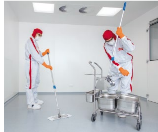
Abb. 1: Reinraumreinigungen erfordern spezielle Gerätschaften: Reinigungswagen aus Edelstahl sind sterilisierbar, Möpfe aus Kunstfasern geben im Gegensatz zu Baumwollfasern 100.000 mal weniger Partikel ab.
