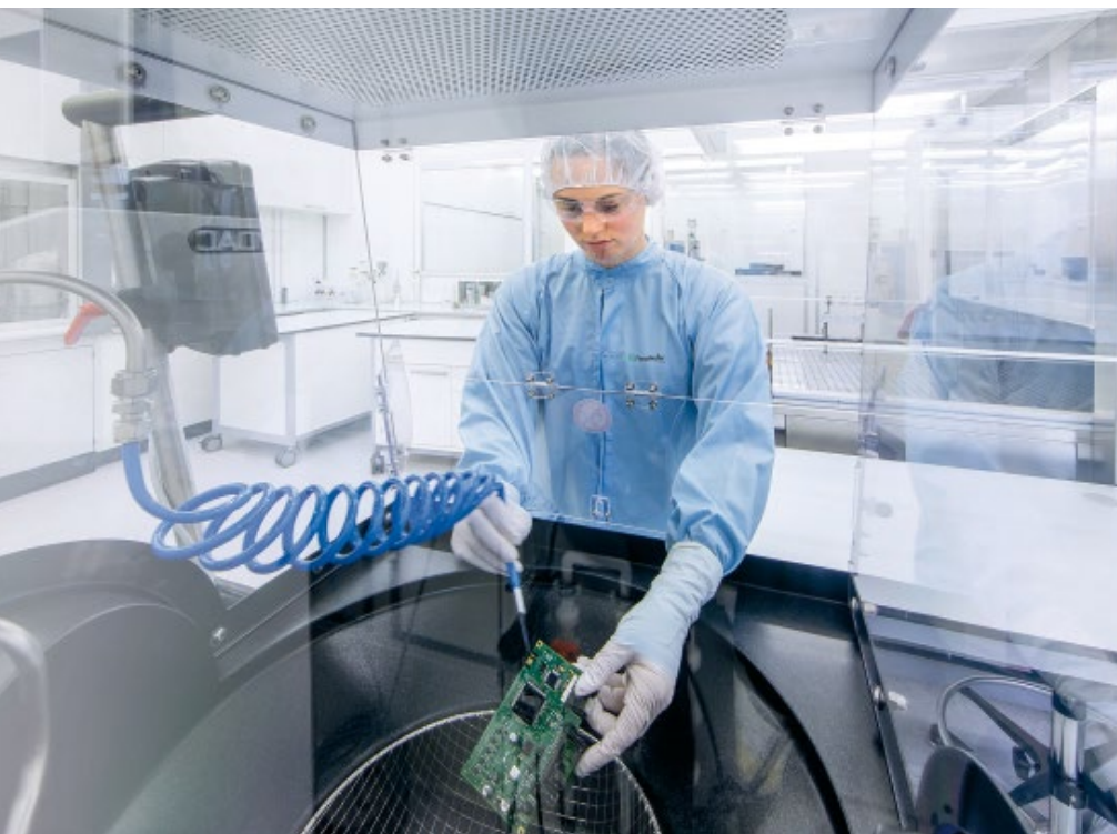
Abb. 1: Anwendung von Extraktionsverfahren nach VDA Band 19 zur Prüfung der Technischen Sauberkeit Quelle: ISS DEBEOS STUDIOS, Foto: Harry Ruckaberle
