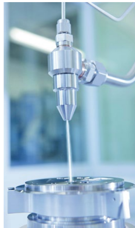
Abb. 2: Die Reinigung mit CO 2 -Schneestrahlen bietet durch die effiziente, lokale und trockene Reinigung zahlreiche Möglichkeiten für eine Integration in automatisierte, serielle Fertigungsprozesse, die mit Flüssigreinigungsverfahren nicht denkbar wären. Quelle: Fraunhofer IPA, Foto: Rainer Bez
