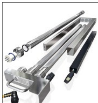
Abb. 2: Im Wesentlichen sind die neuen Bandentkeimer von sterilAir nun mit einem korrosionsfesteren Schutzrohr aus passiviertem V4A-Edelstahl, leistungsoptimierteren UV-Lampen und einer doppelt verstärkten Teflonbeschichtung der Schutzrohre für noch mehr Schutz vor Beschädigungen ausgestattet.
