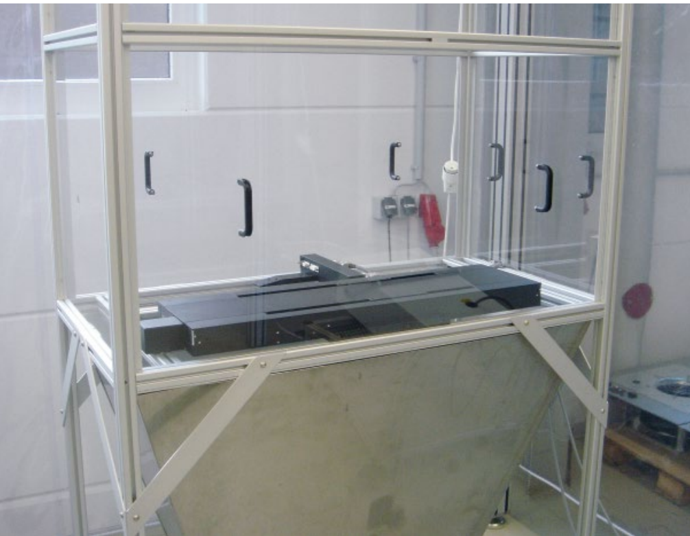
Abb. 2: Messung nach der Ganzheitsmethode: Das Messobjekt befindet sich in einer Messzelle, an deren unterem Ende in einem Trichter die Partikel und der Volumenstrom gemessen werden.
