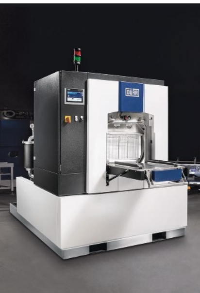
Abb.1: Durch ihr Aufstellmaß von nur 2.100 x 1.630 x 1.855 mm (L x B x H) und ihr geringes Gewicht ermöglicht die EcoCCube einen optimalen Einstieg in die wässrige Reinigung.
