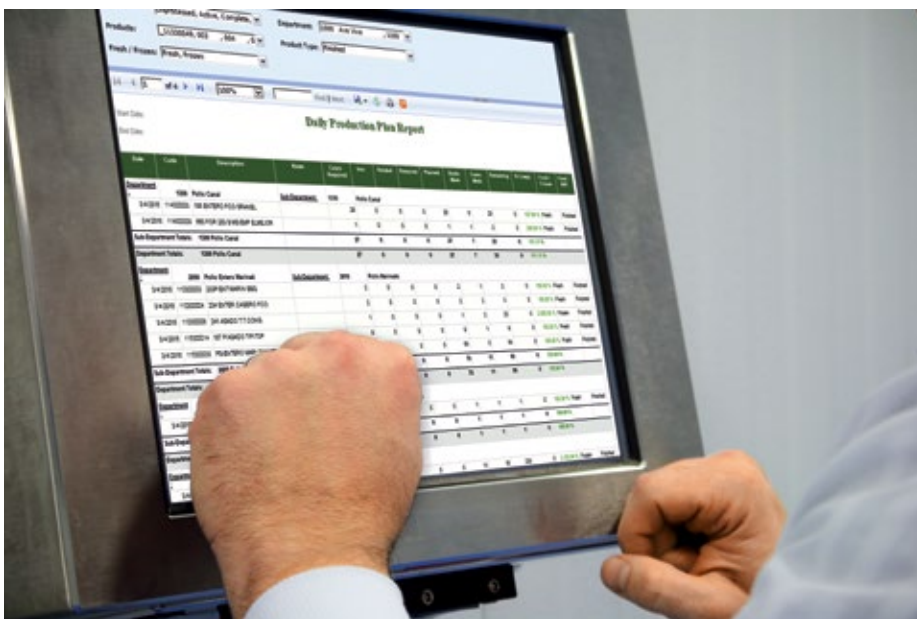
■ Abb. 1: Die IPCs von Noax erfassen und speichern Betriebsdaten, Gesamtanlageneffektivität, Produktivität und Betriebsunterbrechungen.
