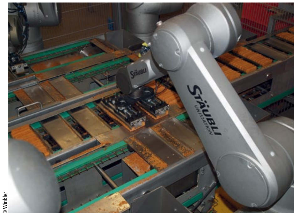
■ Abb. 2: Die gekapselten Stäubli Roboter in HE-Ausführung kommen mit den bröseligen Fischstäbchen und den täglichen Reinigungszyklen gut klar.
