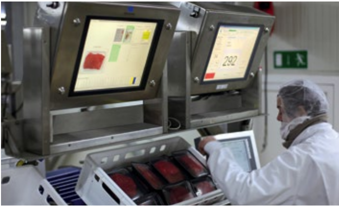
■ Abb. 3: An den CSB-Sortern wird klar visualisiert, welcher Auftrag gerade bearbeitet wird, welche Produkte zum Auftrag gehören und welches Etikett angebracht werden muss.
