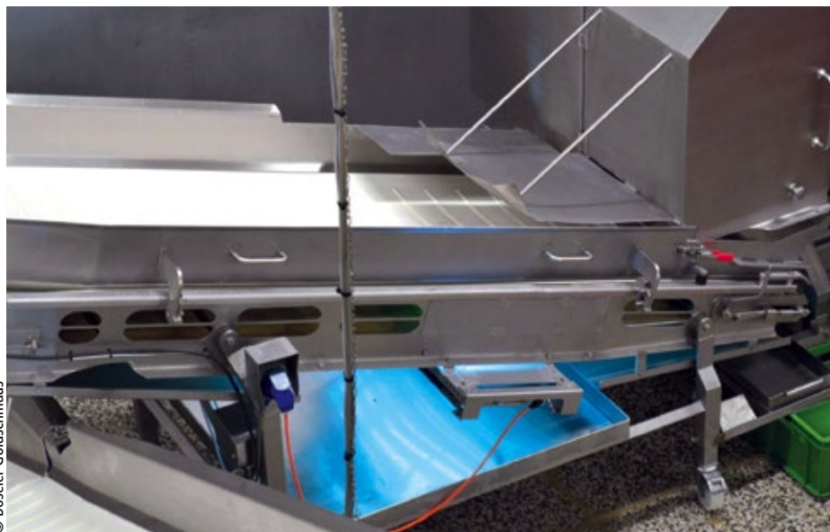
■ Abb. 2: Reflexionen auf Edelstahl: Die UVC-Strahlung inaktiviert die DNA der Mikroorganismen und sichert so jederzeit die Hygieneanforderungen bei der Goldschmaus Gruppe.
