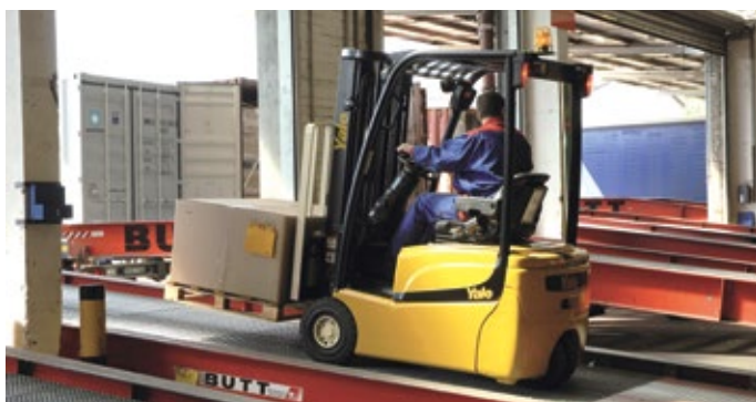
■ Abb. 2: Yale hat bei den Dreirad-Elektrostaplern der Baureihe ERP15-20VT die hydraulische Betriebsbremse durch eine elektronische Bremssteuerung ersetzt und so die Energieeffizienz erhöht.
