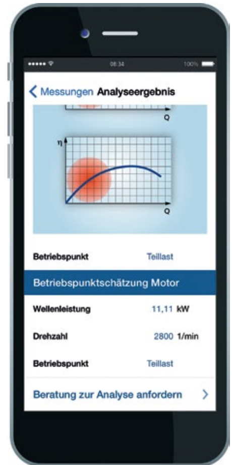
■ Abb. 3: Screenshot des KSB Sonolyzers von der Messung einer teillastig arbeitenden Pumpe.
