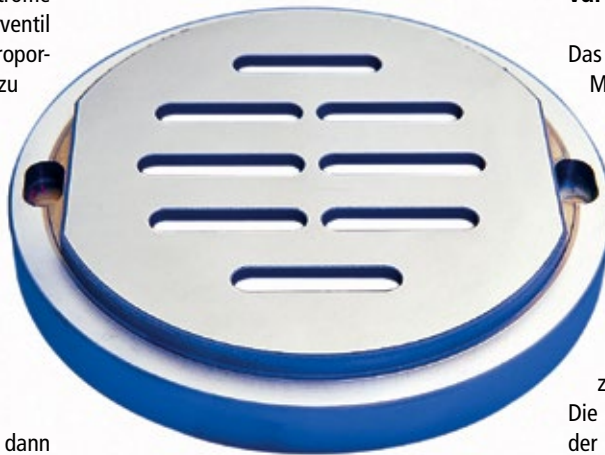
■ Abb. 2: Die aufeinander gleitenden Lochscheiben bilden das zentrale Drosselorgan in Gleitschieberventilen. Da hier auf metallische Sitze verzichtet werden kann, entstehen auch keine Riefen, die in traditionellen Ventilen sehr schnell zu Undichtigkeiten führen.
