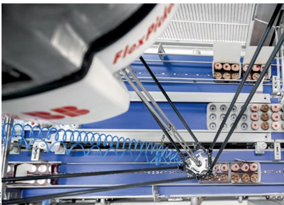
■ Abb. 1: Deltaroboter wie der legendäre ABB Flexpicker haben sich sowohl in der Sekundär- wie in der Primärverpackung von Lebensmitteln hervorragend bewährt.
