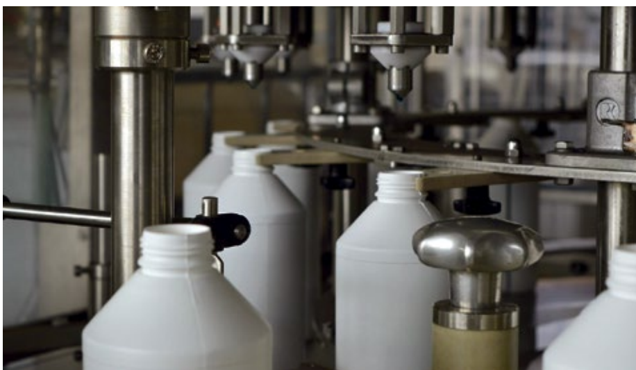
■ Abb. 1: Abfüllmaschinen im Leistungsbereich zwischen 6.000 und 20.000 Flaschen pro Stunde profitieren von der Auslegung mit Rundläufern.
