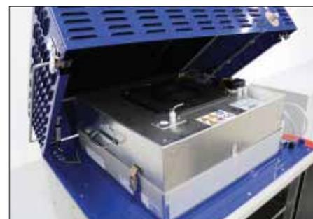
Abb. 2: Die Abdeckhaube des Puros Science ist mit einer Filter-Ventilator-Einheit und Steuerungseinheit zur Versorgung mit Reinstluft ausgestattet.
