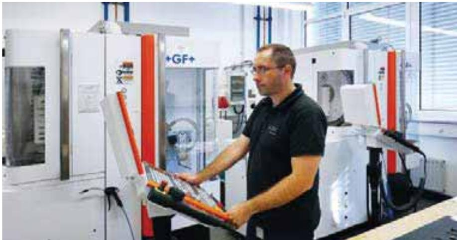
Derzeit beschäftigt der Tooling- & Prototyping-Bereich 34 Mitarbeiter. Dank der Automations-Lösung von GF Machining Solutions konnte die Einführung einer dritten Arbeitsschicht vermieden werden. Die Maschinen laufen jetzt auch über Nacht, so wie die im Bild gezeigte Fräsmaschine vom Typ Mikron HSM 200U LP.
