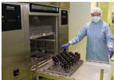
Abb. 6: Vorreinigung der Vials in Durchlademaschine.
