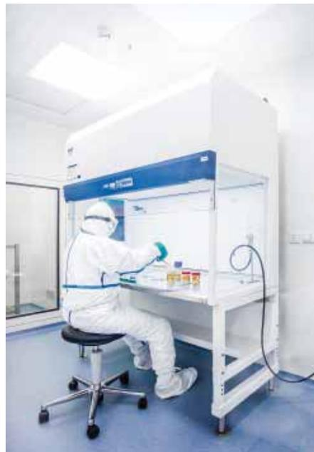
**Abb. 2: Der Sterilitest der Prüfbjekte in der Sicherheitswerkbank** © WISAG Industrie Service Holding, 2016
