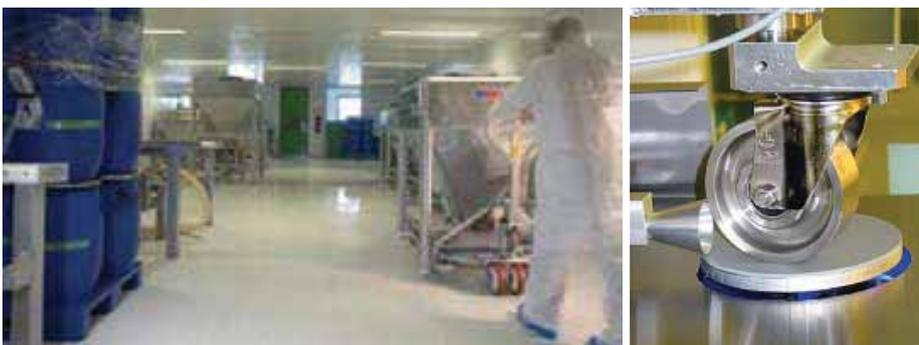
Abb. 3: Ein im Reinraum verwendeter Hubwagen und Simulator. Der Simulator ermöglicht die Messung der durch Fahrbeanspruchung auf einem Bodenbelag im Reinraum bewirkten Partikelemissionen.
