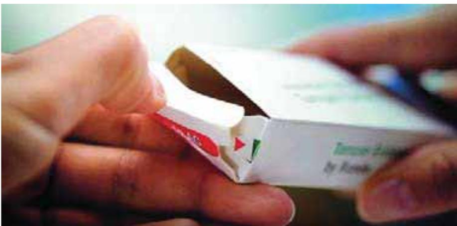
Abb. 3: Schutz vor Fälschung: Ausstanzungen an der Faltschachtel zeigen ein Öffnen der Verpackung deutlich an. © Rondo/Medipak Systems
