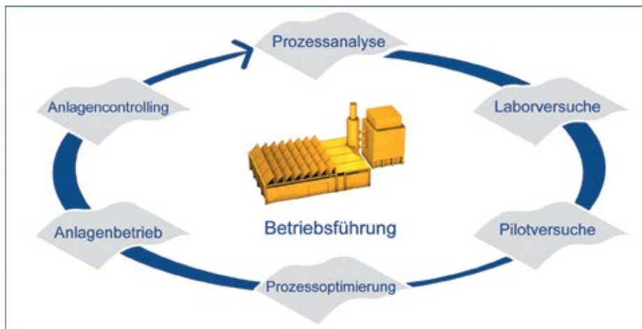
■ Abb. 3: Vorgehensweise von Envirochemie zur kontinuierlichen Optimierung des Anlagenbetriebs während eines Betriebsführungsprojekts.
