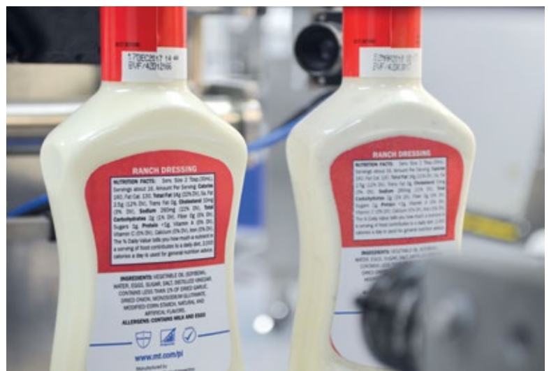
■ Abb. 3: Lebensmittelhersteller können mit einer automatisierten Inspektion der Dot-Matrix-Aufdrucke das Risiko von Serienfehlern und aufwändige Nacharbeiten in ihrer Produktion reduzieren.
