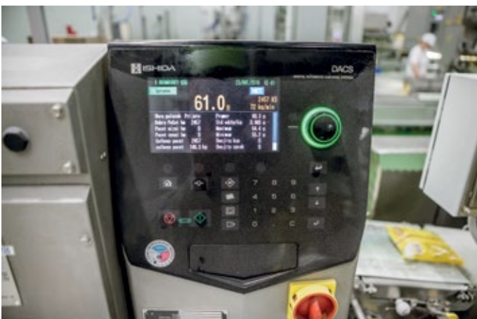
■ Abb. 3: Mit Sicherheit das richtige Gewicht. Die Kontrollwaagen DACS-G sammeln zudem wertvolle Produktionsdaten am Ende der Linie.
