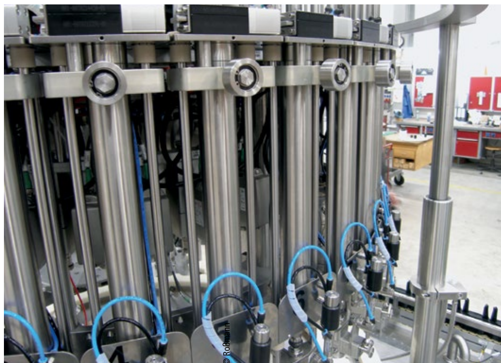
■ Abb. 3: Mit dem Einsatz der Linearmotoren von Linmot entkoppelten die Spezialisten bei Franz Tölke den Füllprozess von der Bewegung des Rundtellers und trieben die Modularisierung voran. Dadurch lässt sich eine Füllstation bei einer Beschädigung wesentlich schneller tauschen.
