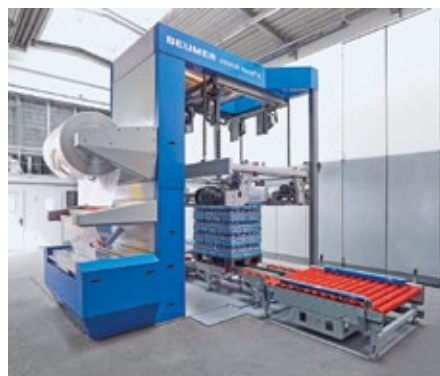
Abb. 5: Der neue stretch hood A lässt sich mit einer Easy-Opening-Folie ausstatten.
