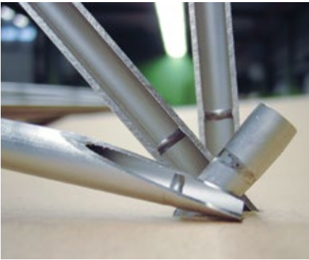
Abb. 2: WIG-Orbitalschweißnaht von innen: Um die von den Kunden geforderten 15.000 m und mehr liefern zu können, werden Einzelringe durch eine Orbitalschweißung verbunden. Eine zusätzliche Röntgenprüfung stellt sicher, dass die Schweißung porenfrei und dicht ist.
