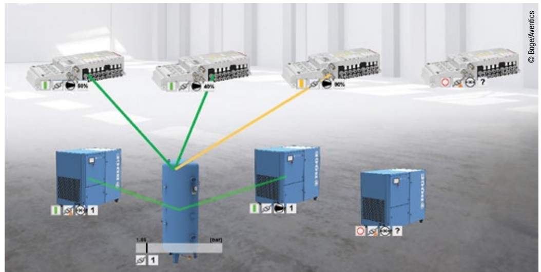
Abb.: Das Smart Pneumatic Grid erfasst den Energiebedarf bis auf Einzelverbraucherebene
