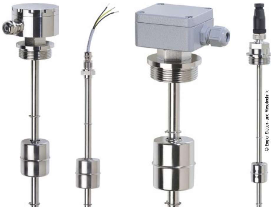
Abb.: Schwimmerschalter fungieren als berührungslos arbeitende Magnet-Schalter aus Edelstahl, die für die Füllstandüberwachung in Behältern verantwortlich sind. Sie sind so konzipiert, dass der Einsatz in vielen Industriebereichen möglich ist.
