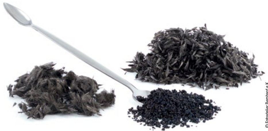
Abb.: Verbesserung der Materialeigenschaften von Kohlenstoff-Kurzfasern durch eine modifizierte Formgebung. Aufbereitete Fasern mit verbesserten Fließigenschaften und damit besserer Dosierbarkeit.
