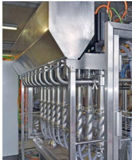
Abb. 2: In dieser linearen Abfüllanlage MFL010 von Bündler & Schmitt sind die zehn Stationen mit Knoll Exzenterschneckenpumpen MX ausgestattet.
