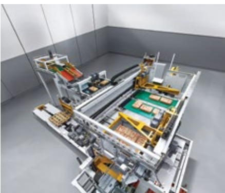
Abb. 4: Der palletpac erstellt exakte, stabile und damit platzsparende Sackstapel.
