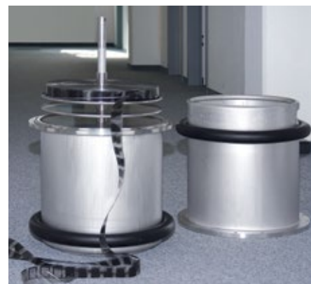
Abb. 3: Immer 16 Großrollen werden übereinander in Behälter aus Edelstahl Rostfrei gepackt, bevor sie vier Wochen lang in einer Klimakammer lagern.
