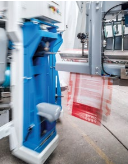
Abb. 2: Der Sackaufstecker schiebt den Ventilsack präzise auf einen der Füllstutzen des fillpac R auf.
