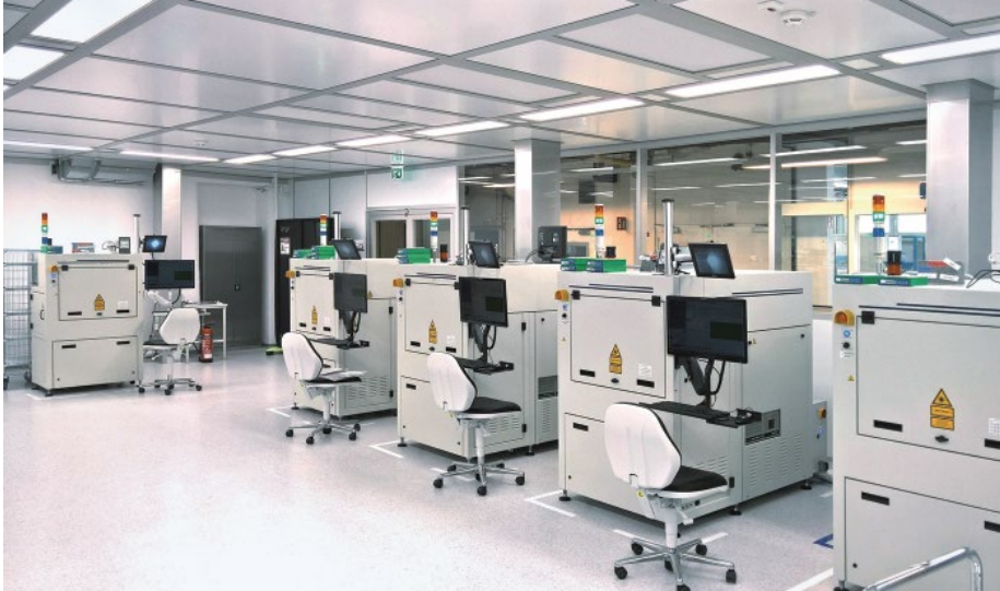
Abb. 1: Herstellung von hochstabilen Widerständen in der neuen Reinraumanlage von Vishay in Selb
