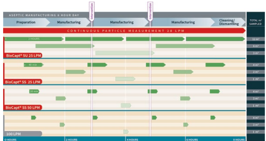
Abb. 2: Konzept der kontinuierlichen Luftkeimsammlung. Wie man sieht, können kurze Probenahmen mit hoher Fließrate (100 LPM, unten) nur Schnappschüsse des Prozesses liefern, während eine Sammlung von 2h bei niedrigerer Fließrate (25 LPM) den gesamten Prozeß abdecken kann.
