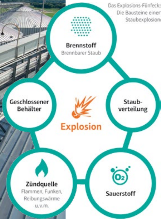
Abb. 1: Jede Anlage mit Staubeentwicklung birgt das Risiko einer Staubexplosion. Das Explosionsfünfleck rechts zeigt die Bausteine einer Staubexplosion.
