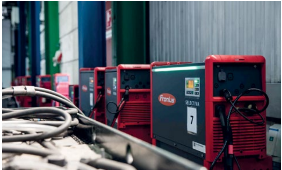
■ Abb. 2: Die Selectiva-Ladegeräte von Fronius senken mit dem sparsamen Ri-Ladeprozess den Energieverbrauch um bis zu 30 % und verlängern die Lebensdauer der Antriebsbatterien.
