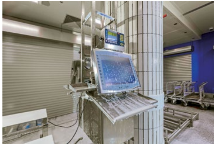
■ Abb. 3: Verlässliche Leistung: Bereits seit zwei Jahren werden die Noax IPCs täglich mit hochkorrosiven Desinfektionsmitteln eingeschäumt und abgespritzt.
