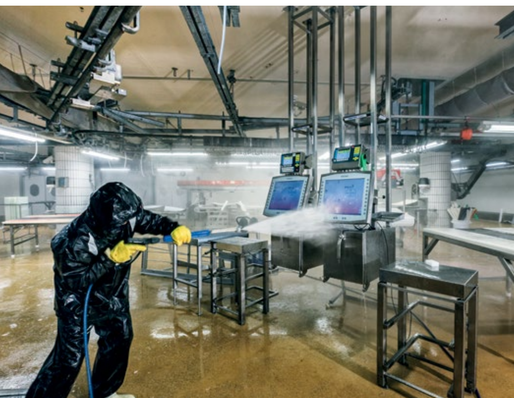
Abb. 1: Am Freitag wird mit Reinigungsmitteln gearbeitet, die ein saures Milieu erzeugen. An den anderen Wochentagen kommen alkalische Substanzen zum Einsatz.
