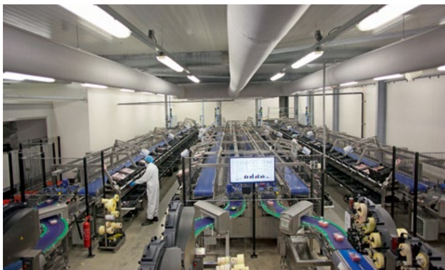
■ Abb. 3: Blick in die Kommissionierung: Die vier automatischen Sorterlinien können stündlich zwischen 5.000 und 7.500 Packungen zu Mischgebinden zusammenführen.
