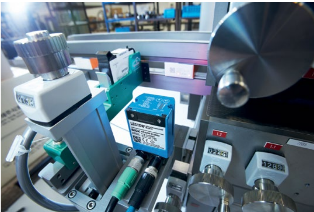
■ Abb. 1: Die kamerabasierten Codelesern der Produktfamilie Lector 620 OCR erlauben es, über Barcodes hinaus auch diese 2D-Codes sowie Klarschriftinformationen sicher zu erfassen.
