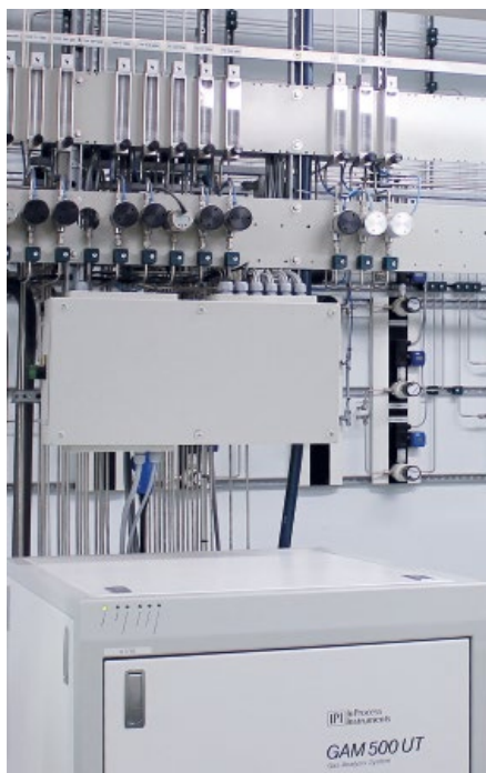
Abb. 3: Anlage zur massenspektrometrischen Bestimmung für Ultraspuren von technischen- und Reinstgasen
