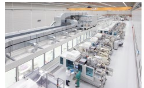
Abb. 3: Bei Pöppelmann FAMAC produzieren die Spritzgussmaschinen von außen in den Reinraum hinein, sie können bei Bedarf abgekoppelt und in anderen Bereichen eingesetzt werden.
