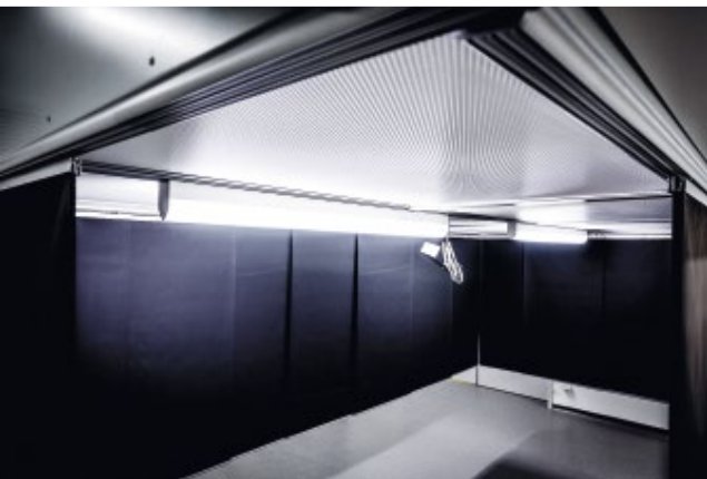
Abb. 2: Hohe Anforderungen an die Schutzvorhänge: lichtdicht schwarz, nicht brennbar, in geringem Umfang lösungsmittelbeständig und abwaschbar
