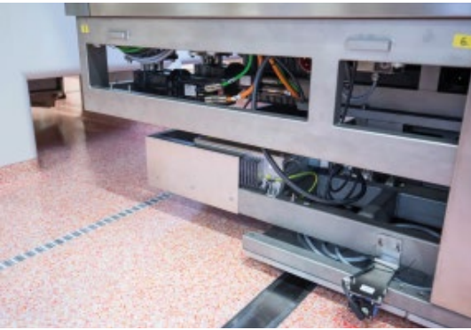
Abb. 1: Der mobile Reinraum wird über Linienleiter im Boden und mehrere Übertragerköpfe mit Energie versorgt. Barcode Linear-Messensoren erfassen die Position der Fahrzeuge.
