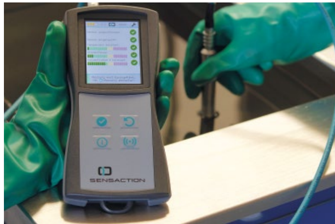
Abb. 1: Bei wässrigen Reinigungsmedien ermöglicht ein mobiles Messgerät die einfache und zuverlässige Kontrolle der Builderkonzentration im Reinigungsmedium.
