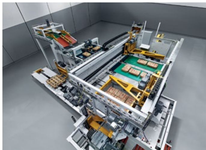
Abb. 2: Der Beumer Paletpac erstellt exakte, stabile und damit platzsparende Sackstapel.
