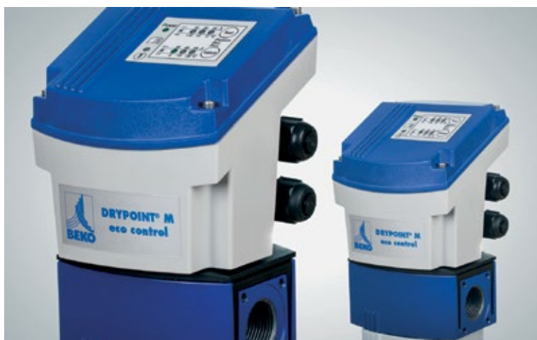
Abb. 3: Der Membrantrockner Drypoint M eco control von Beko verfügt über ein elektronisch geregeltes Trocknungssystem, bei dem erstmals ein fester Drucktaupunkt zwischen +10 °C und -26 °C oder ein fester Abstand zwischen Drucklufttemperatur und Austritts-Drucktaupunkt einstellbar ist.
