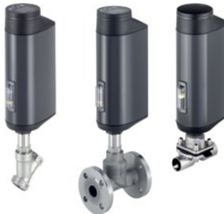
Abb. 2: Die elektromotorischen Prozessregelventile – ausgelegt als Sitz- oder Membranventile – bieten sich als energieeffiziente Alternative zu pneumatischen, federbalancierten Ventilen an.
