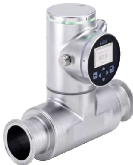
Abb. 2: Das Inline-Durchflussmessgerät arbeitet nach dem patentierten SAW-Verfahren (Surface Acoustic Waves), nutzt also Oberflächenwellen zur Messung. Vorteil dieses Verfahrens ist vor allem, dass es keinerlei Einbauten oder Verengungen und damit auch keine Toträume im Messrohr gibt.
