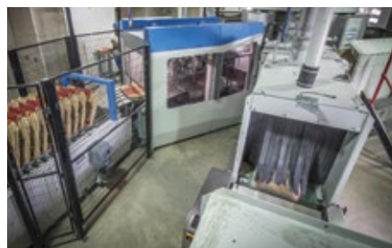
Abb. 1: Mit dem bag placer und dem Sackbündelmagazin von Beumer lässt sich die Leistung und Effizienz der Abfüllmaschine Fillpac noch weiter steigern.
