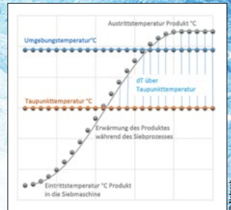
Abb. 4: Beispiel für Produkterwärmung: Die Erwärmung des Mahlguts innerhalb des geschlossenen Systems verhindert die Kondensation von Wasser auf der Oberfläche der Partikel unter atmosphärischen Bedingungen.
