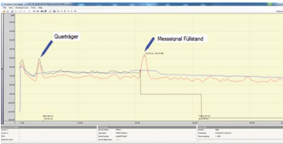
Abb. 2: Die Hüllkurve zeigt deutlich den Querträger unterhalb des Silodachs und das starke Füllstandsignal im unteren Silodrittel.
