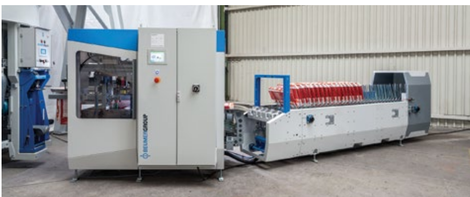
Abb. 2: Das Greifsystem und die Aufschusseinheit stecken die Säcke sicher auf den Füllstutzen.
