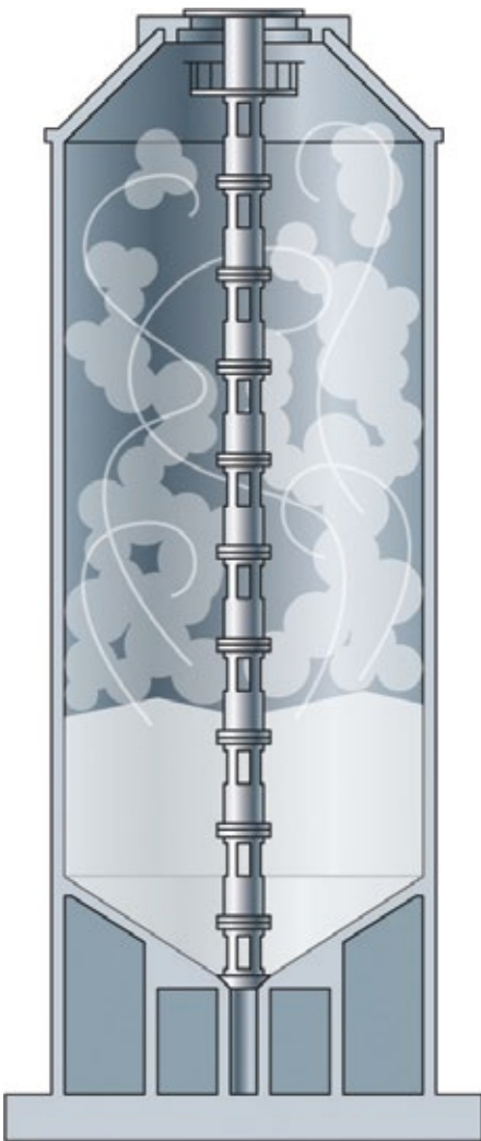
Abb. 1: Klinkersilo mit Zentralsäule.
