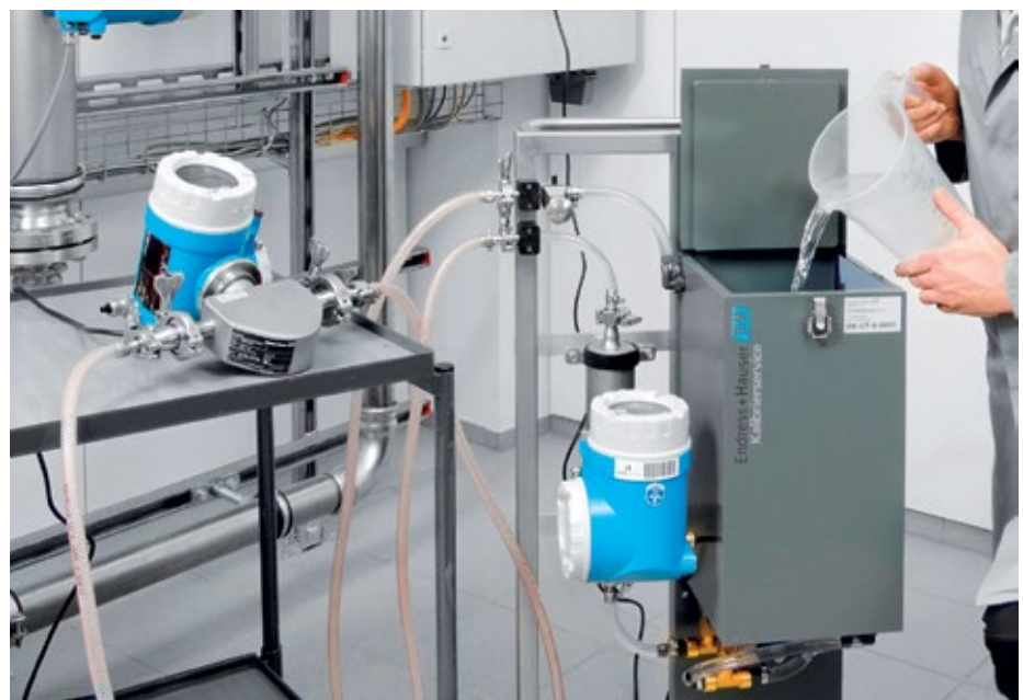
Abb. 5: Zum Patent angemeldetes Verfahren zur Dichtekalibrierung vor Ort reduziert den Anlagenstillstand.
