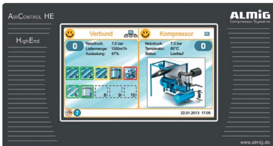
Abb. 4: Die Steuerung Almig Air Control HE regelt die beiden Kompressoren im Verbund. Damit lassen sich die Energievorteile der Drehzahlregelung voll nutzen.
