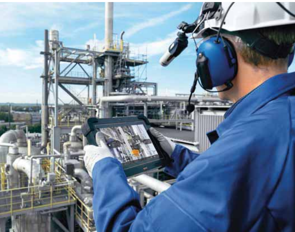
Abb. 1: Zur eindeutigen Anlagenidentifizierung verfügt das Agile X über einen rückseitigen RFIDReader. Hält der Operator das Mobilgerät nahe genug an den Transponder, wird die Teilanlage eindeutig identifiziert und automatisch das korrekte Prozessbild aufgeschaltet.
