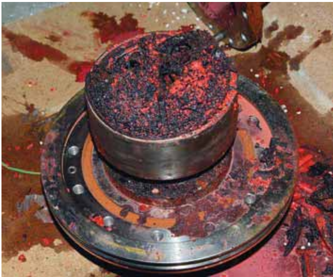
Abb. 3: Betrieb gegen geschlossene Druckseite mit Chlotianidin-Wassersuspension, Pumpenrotor nach Demontage.
