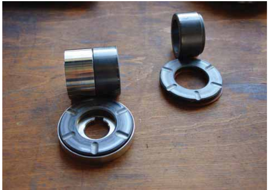
Abb. 2: Gleitlagerbauteile ohne Beschädigung nach 10-stündigem Betrieb mit Isopropanol mit geschlossener Saugseite.
