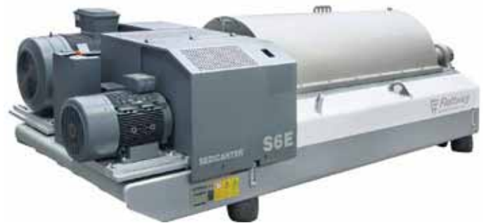
Abb. 3: Flottweg produziert eine spezielle Dekanterzentrifuge für weiches Sediment. Der Flottweg Sedicanter trennt Feststoffe aus Flüssigkeiten ab. © Flottweg SE
