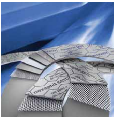
◀ Abb. 1: Streckmetalleinlage und XP-Technologie gewährleisten in novaphit-Dichtungen eine optimierte Flächenpressung, minimalen Masseverlust und hohe Dichtheit bei Hochtemperaturanwendungen.
