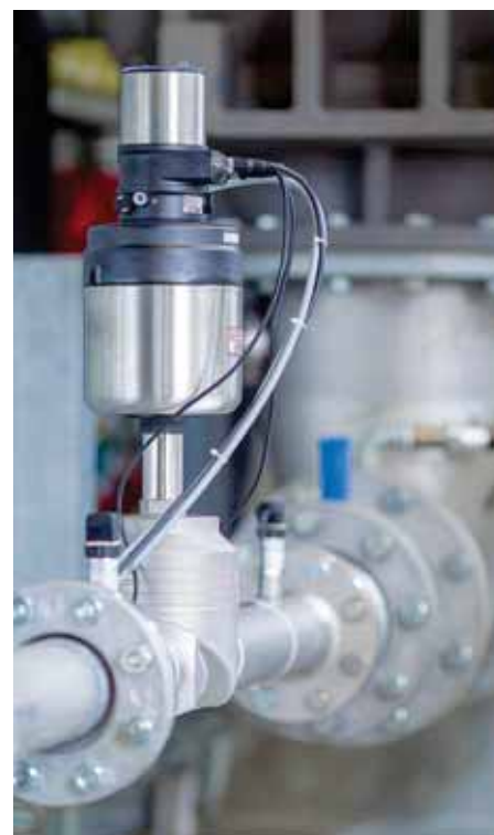
Abb. 1: Luftdurchflussregler mit geschlossenem Regelkreis: Zuverlässige Luftmengenregelung für die stabile Förderung von Schüttgütern.
