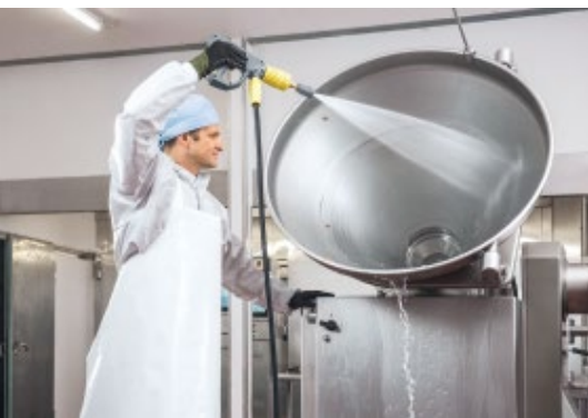
Abb. 3: Abreinen von fettigen Verschmutzungen mit einem Zielstrahl-Hochdruckreiniger im Lebensmittelbereich. © Alfred Kärcher GmbH & Co. KG, Winnenden
