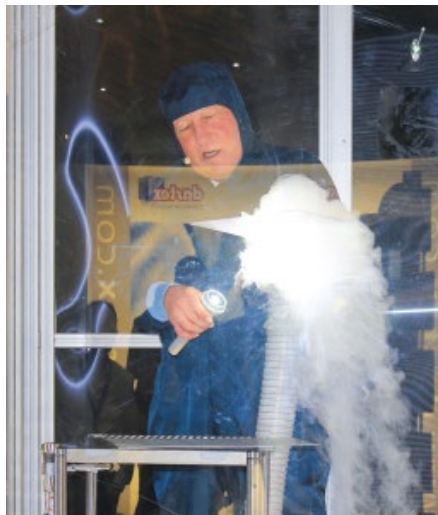
Abb. 6: CCI – Thomas von Kahlden in der mobilen Body-Box zur Messung der Partikelemission von Personen im Reinraum. Er demonstrierte, dass Oberflächenparameter die Messungen der Kontamination beeinflussen können. Auch die Partikelbewegung durch Gravitation, Elektrostatik und die Strömung der Luft beeinflussen die Messströmung.
