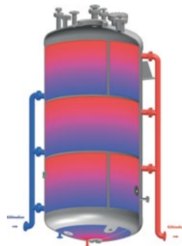
Abb. 2: Darstellung des Reaktors und des Temperaturverlaufs
