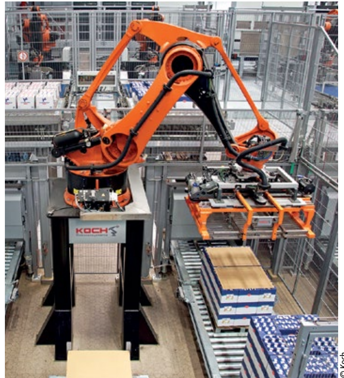
■ Abb. 1: Vollautomatisches Hochleistungs-Palettierzentrum für Milchtrays – Vorgruppierung und Plattierung von 4.800 Trays je Stunde im 24 h-Betrieb.
