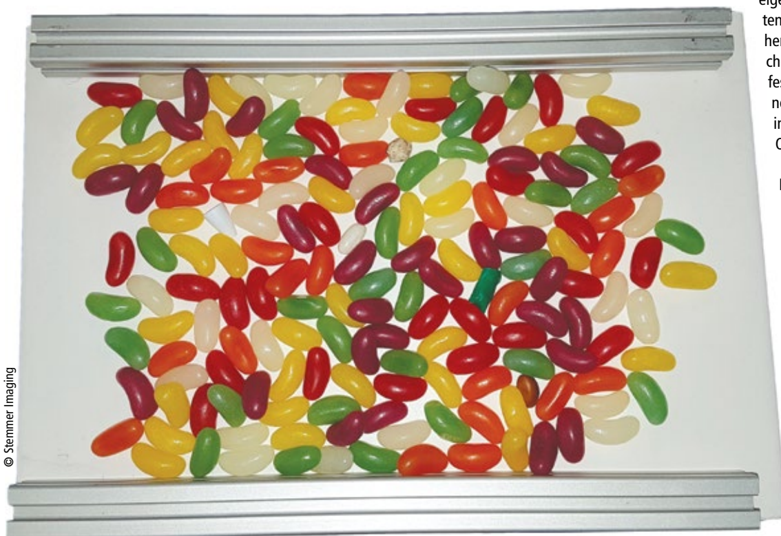
■ Abb. 1: Jelly Beans - aufgrund unterschiedlicher Formen und Farben, aber ähnlicher Dichte, können nichtmetallische Fremdkörper mit konventionellen Methoden nur schwer identifiziert werden.
