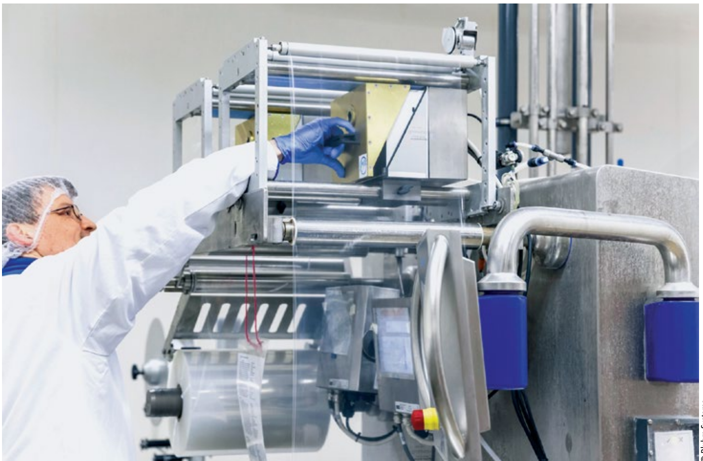
■ Abb. 1: Der Thermotransferdirektdrucker sitzt in einem besonderen Flexi-Clean-Gehäuse mit Schutzart IP 65, das es gegen Feuchtigkeit schützt. Bei Nassreinigung der Produktionslinie muss der Drucker nicht langwierig ausgebaut werden.
