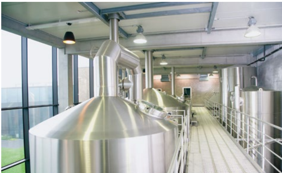
■ Abb. 5: Die Sudgröße des neuen Vier-Geräte-Sudwerks beträgt 115 statt wie bisher 200 bis 300 hl je nach Sorte. Dabei ist bemerkenswert, dass Van Honsbrouck die Jahreskapazität dennoch mehr als verdoppelt hat – von 100.000 hl im alten Werk auf 250.000 hl in der neuen Braustätte.
