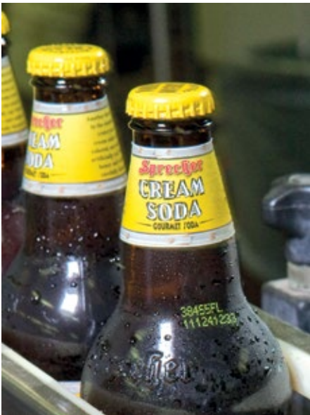
■ Abb. 2: Die CIJ-Technologie verwendet verschiedene Tintentypen, wie etwa schnell trocknend, entfernbar, kontrastreich, lebensmittelecht und kondenswasserdurchdringend, je nach Art der Anwendung.
