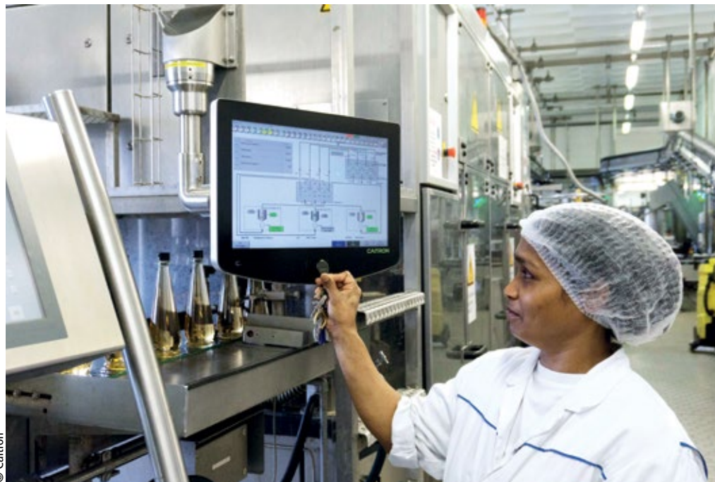
■ Abb. 2: Integrierte RFID-Leser: Die Hengstenberg-Mitarbeiter melden sich mit ihrem Token direkt am IPC an der Produktionslinie an.
