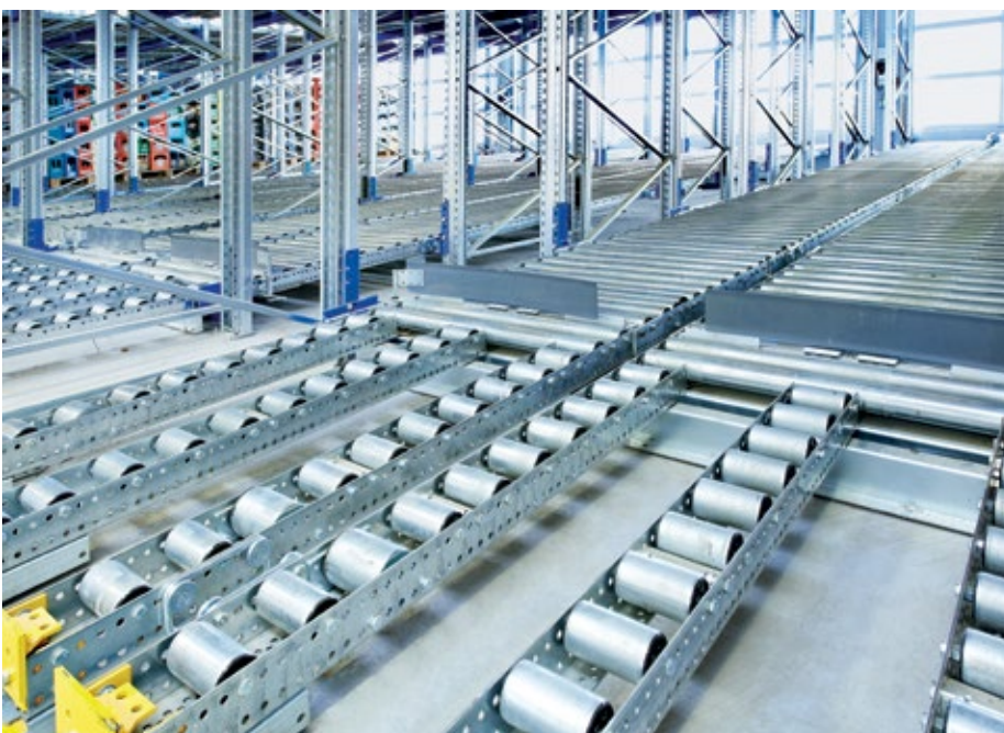
■ Abb. 2: Die Durchlaufebenen sind mit der innovativen Nachlaufsperrere Flowstop ausgestattet.
