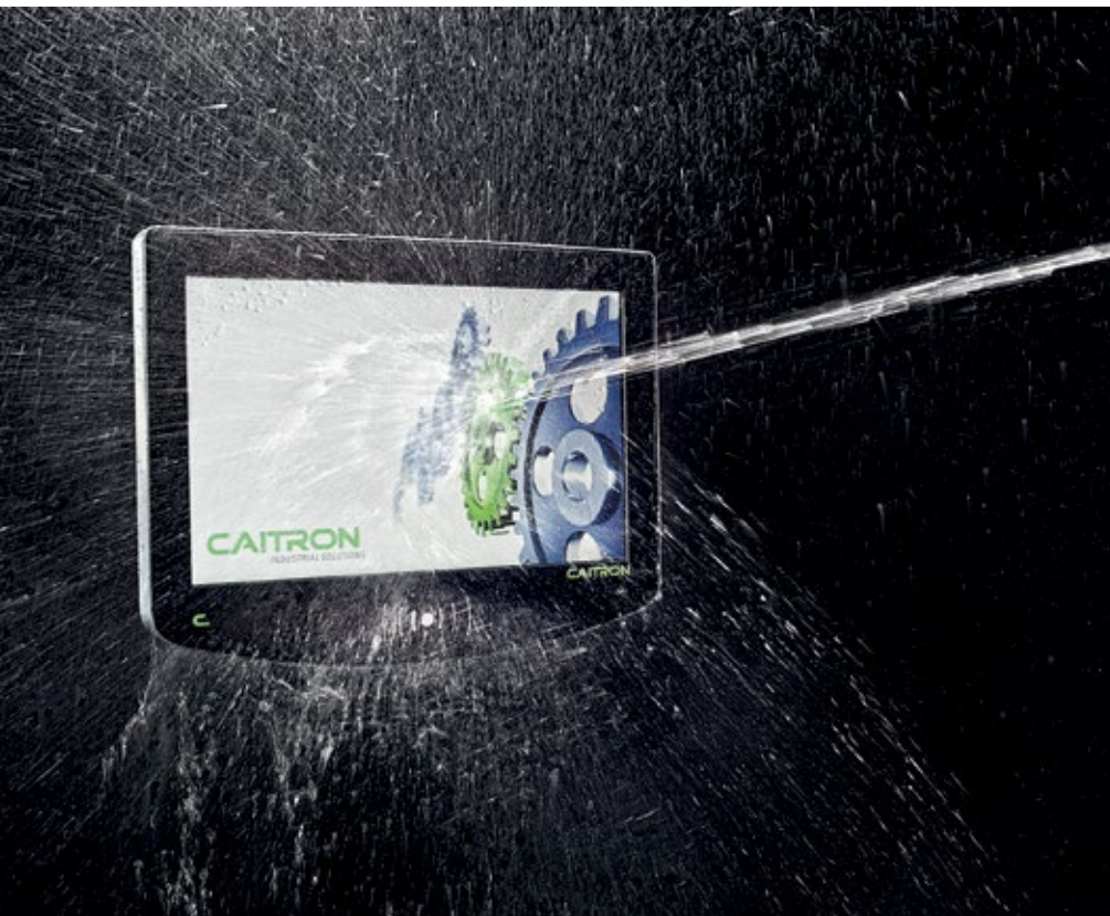
■ Abb. 1: Hengstenberg setzt in der Produktion Hygiene-IPCs ein, die sich dank Schutzklasse IP69k und lebensmittelechten Dichtungen mit Hochdruckreinigern und aggressiven Reinigungsmitteln säubern lassen.
