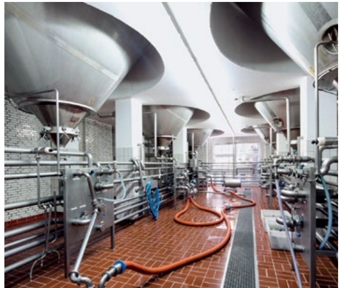
■ Abb. 3: Zum Gären und Reifen wird das Bier auf bis zu -2 °C gekühlt und verbleibt dort über Wochen hinweg.
