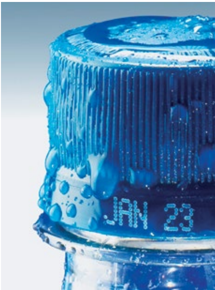
■ Abb. 4: Das Beschriftungsgerät Videojet 1710 bringt helle, saubere Codes auf dunkle oder schwierig zu kennzeichnenden Oberflächen. Dieser CIJ vermag mit sehr kontrastreicher, pigmentierter Tinte überall dort zu drucken, wo herkömmliche, wasserlösliche Tinten versagen wie z. B. auf Kunststoffverschlüssen, gefärbtem Glas, Gummischläuchen, Kunststoffkabel oder auf dunkler Pappe. Das System beherrscht Schriften in vielen Sprachen, Barcodes, 2D Data Matrix Codes, kundenspezifische Logos und Grafiken.
