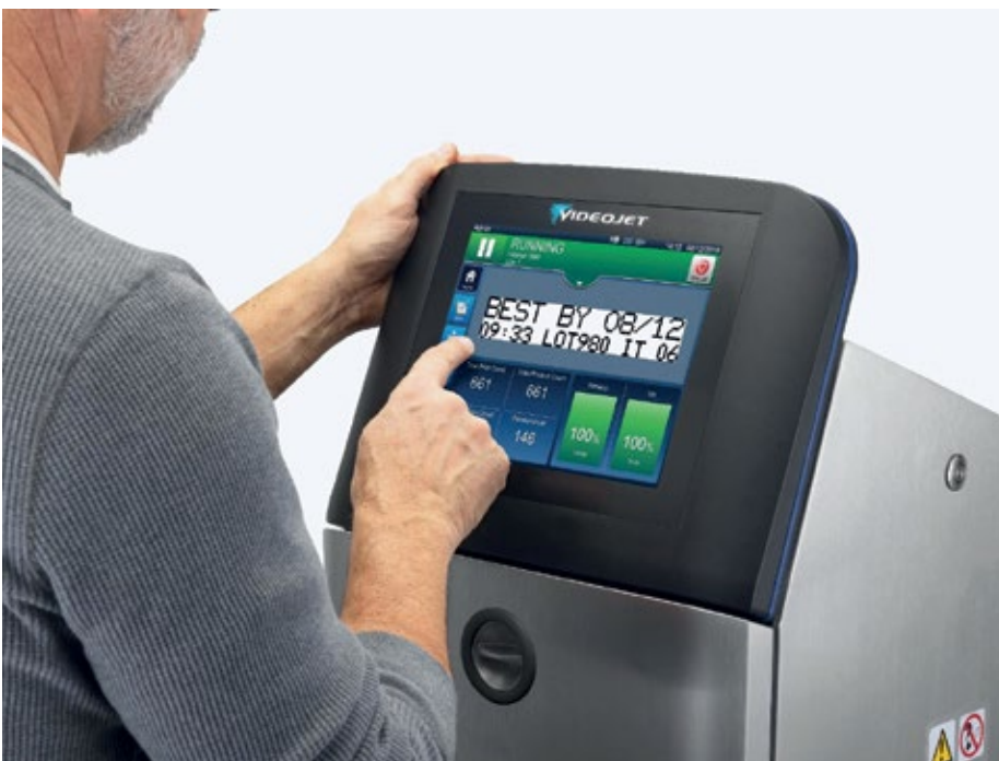
■ Abb. 3: Der Videojet Continuous Inkjet Drucker 1860 gibt frühzeitige Warnungen aus, bevor Düsen verstopfen und Fehler auftreten. Die neue Simlicity-Oberfläche schränkt die erforderlichen Benutzereingriffe erheblich ein, während der optionale Videojetconnect Remote Service den Bedarf an Wartungseinsätzen vor Ort spürbar verringert.
