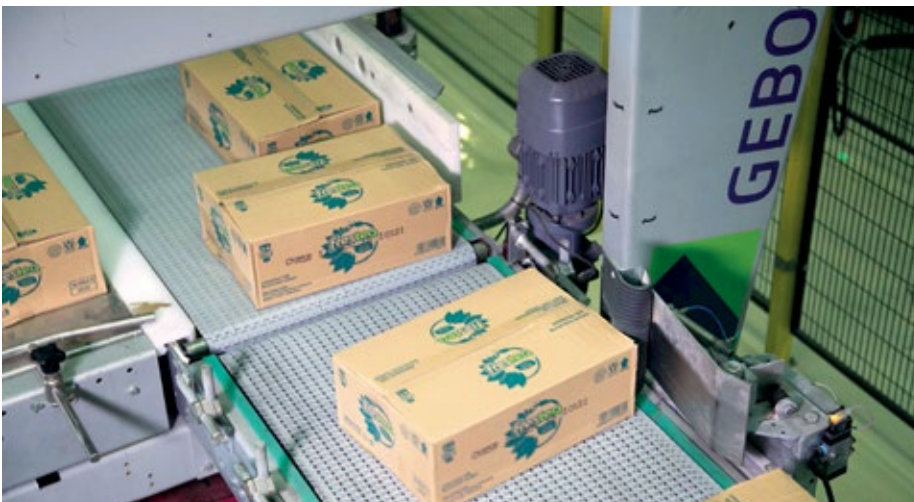
■ Abb. 3: Die für den Bedarf des Cikedokan-Werks entwickelte automatische Palettierlösung vereint Lagenpalettierer, Palettenförderer und einen Stretchwickler. Im Karton verpackt ist Tee in Kunststoffbechern für die asiatischen Märkte.
