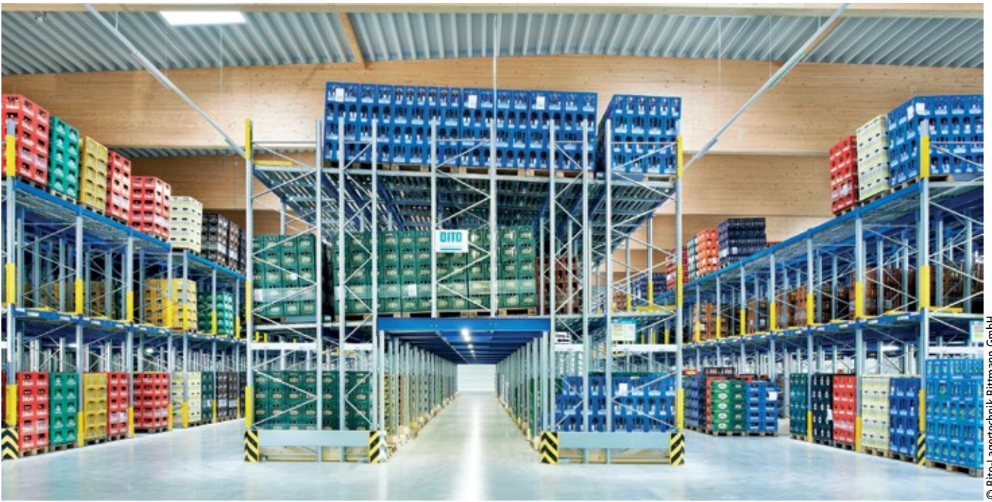
■ Abb. 1: Bito lieferte für das Verteilzentrum von Fristo eine Paletten-Durchlaufregalanlage mit Kommissioniertunneln. Darin lagert der Getränkehändler Schnelldreher und stellt diese für Auslieferungstouren rasch bereit.
