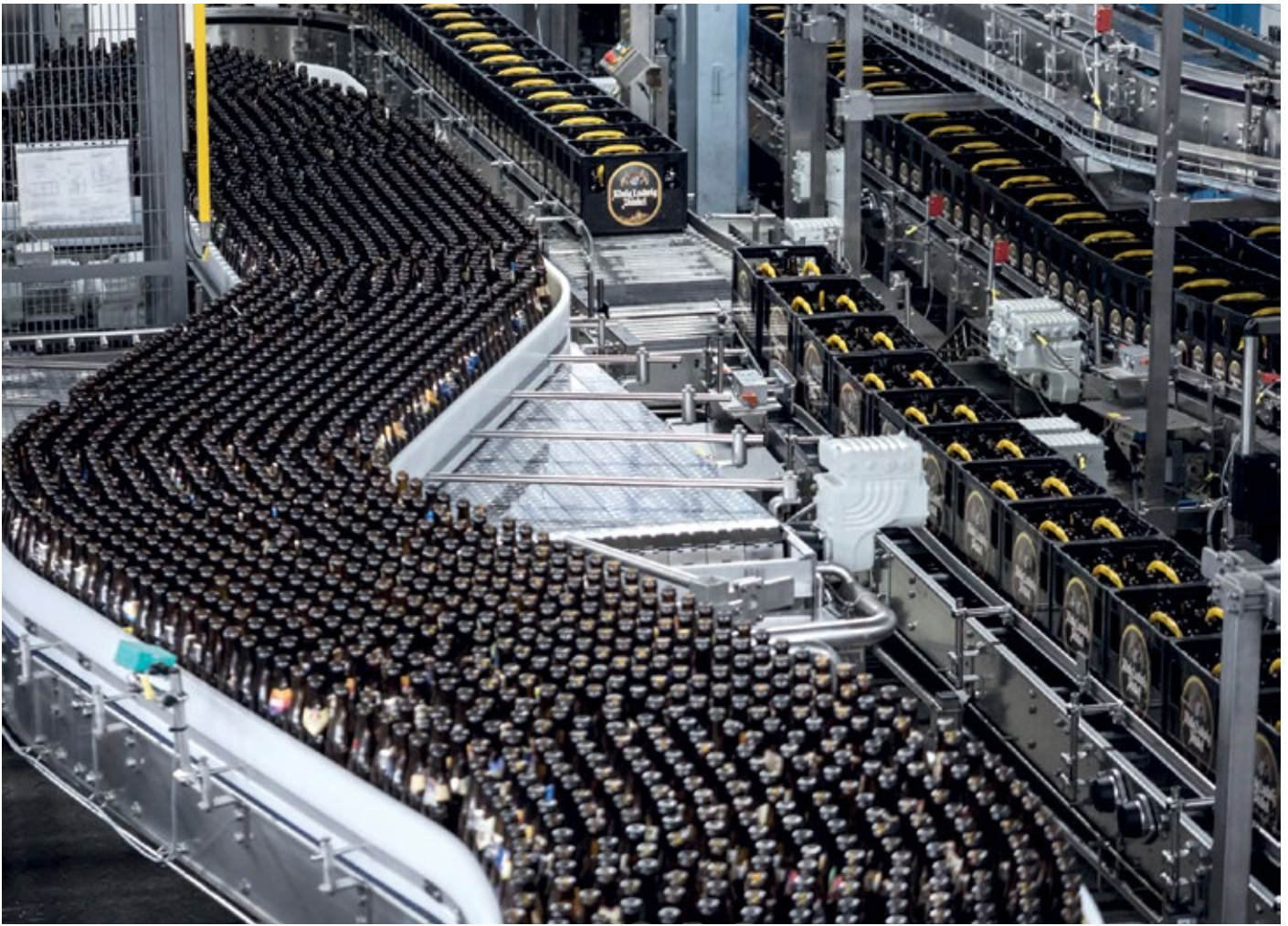
■ Abb. 4: Für den energieeffizienten Flaschentransport am Zulauf der Waschmaschine sorgen mechatronische Antriebseinheiten „MGF..-DSM“ von SEW-Eurodrive.
