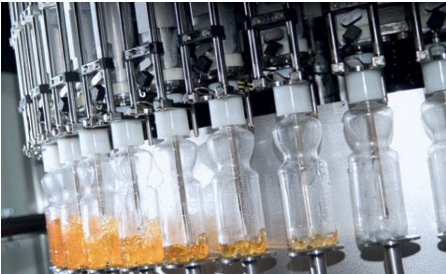
■ Abb. 2: Das Langrohr-Füllventil füllt mit zwei Geschwindigkeiten unterschichtend. Diese Verfahrensweise minimiert einerseits die Sauerstoffaufnahme, andererseits verhindert sie eine Schaumbildung.
