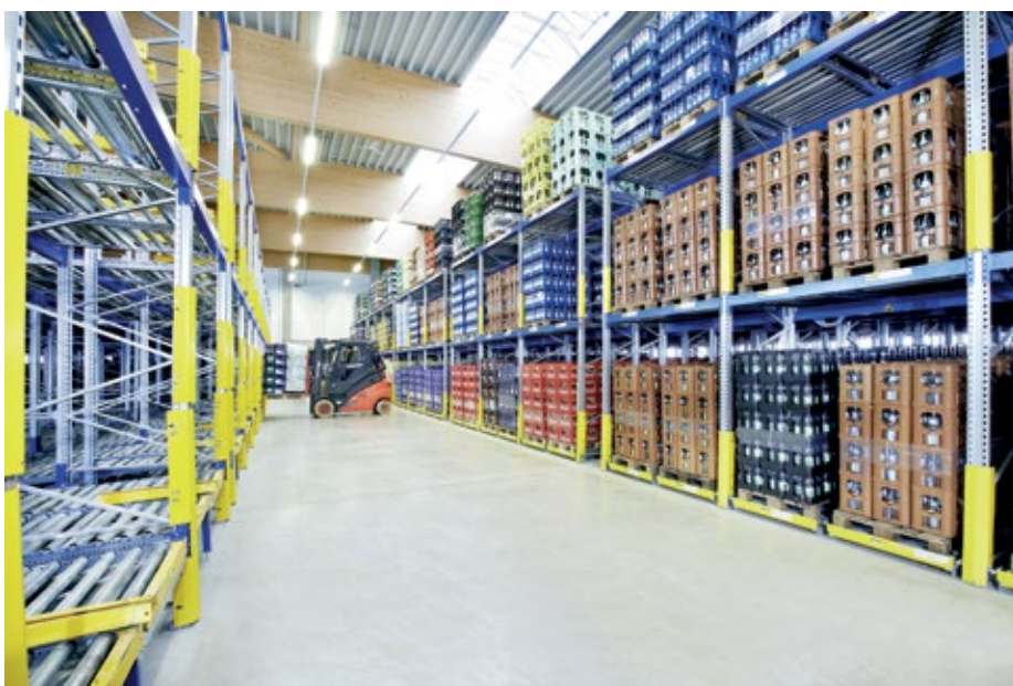
Abb. 4: In der Vollguthalle setzen die Mitarbeiter mit Treibgasstaplern die Paletten in die Durchlaufkanäle.
