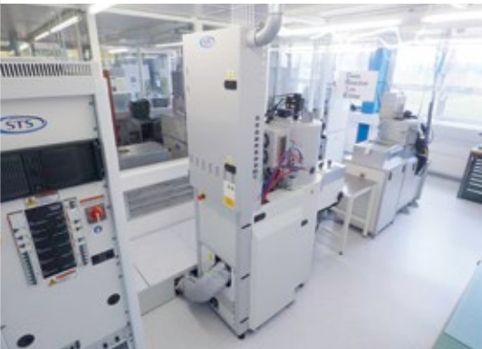
Abb. 3: Links: In der Bildmitte ist die Plasmaätzanlage für das tiefe Siliziumätzen zu sehen. Rechts hinten steht eine weitere Plasmaätzanlage für die Strukturierung von Siliziumoxid und -nitrid. Rechts: Blick von oben durch ein Fenster auf den Wafer, über dem gerade das Prozessplasma brennt.
