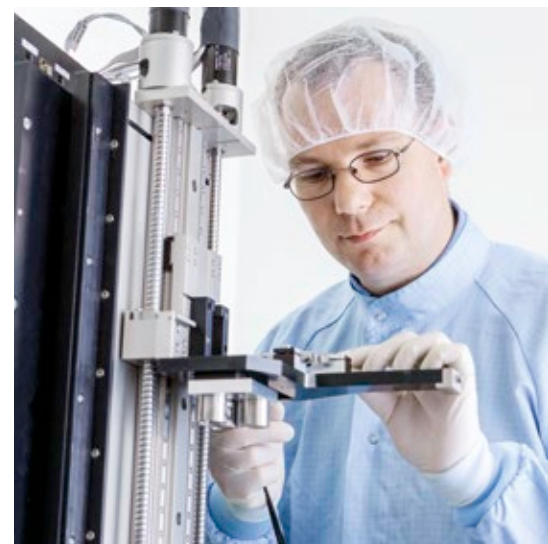
Abb. 2: Montage der Kreuztische. © Steinmeyer Mechatronik
