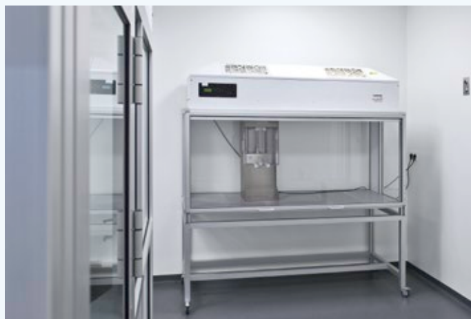
Abb. 5: Einsatz von separatem Reinraumarbeitsplatz umgesetzt als Laminar Flow Box
