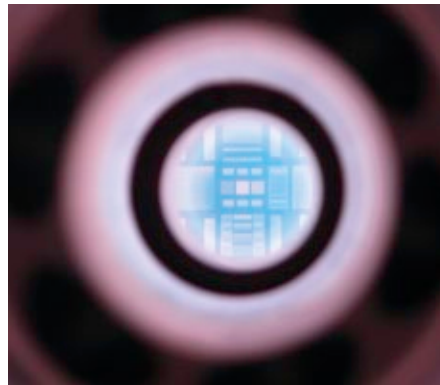
Abb. 3: Links: In der Bildmitte ist die Plasmaätzanlage für das tiefe Siliziumätzen zu sehen. Rechts hinten steht eine weitere Plasmaätzanlage für die Strukturierung von Siliziumoxid und -nitrid. Rechts: Blick von oben durch ein Fenster auf den Wafer, über dem gerade das Prozessplasma brennt.
