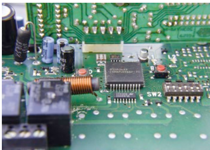
Abb. 2: Partikelverschmutzungen stellen gerade bei elektronischen Baugruppen ein erhöhtes Risiko dar: Der Zentralverband Elektrotechnik- und Elektronikindustrie (ZVEI) benennt in seinem Leitfaden „Technische Sauberkeit in der Elektrotechnik“ neun mögliche Störungen wie Kurzschlüsse oder elektrische Isolationen, die zur Funktionsunfähigkeit führen können.
