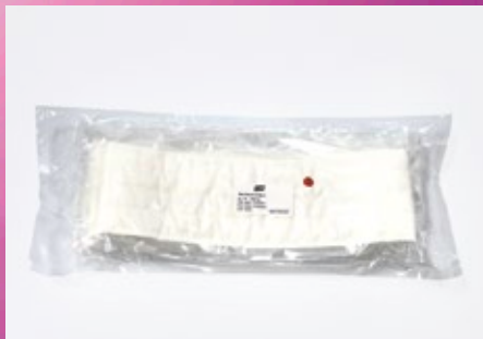
Abb. 1: Parallel zur Überprüfung der Sterilisation wird die Eignung der Verpackung geprüft. Ein anwendungstechnischer Vorteil bietet ein leichtes Vakuum ohne die Funktionalität der Fasern zu beeinträchtigen.
