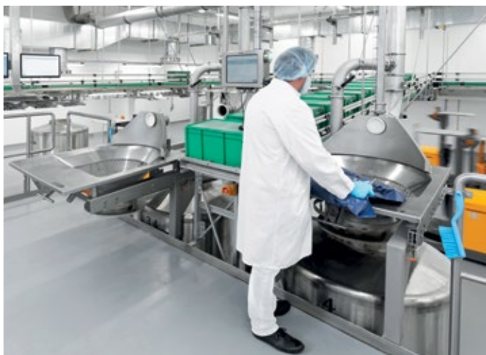
■ Abb. 2: Nach dem Einsammeln der automatisch dosierten Komponenten wird der Container unter Handaufgabestationen positioniert. Hier werden alle Klein- komponenten als Ganzgebilde und/oder Teilmengen aus dem KKL aufgegeben
