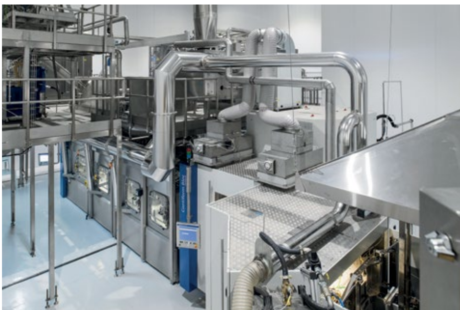
■ Abb. 3: Der Contipure Aseptbloc DA, bis 2017 bezeichnet als Contiform Bloc, entkeimt die Preforms mit H 2 O 2 und füllt die starksauren Getränke aseptisch im Isolator ab.
