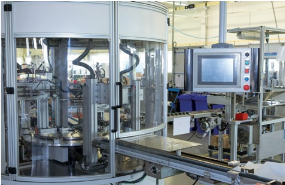
Abb. 2: Abnehmbare Inspektionsklappen ermöglichen den Zugang zu den Transportbändern im Hygienebereich für Routinewartung und Einrichtung oder Fehlersuche.
