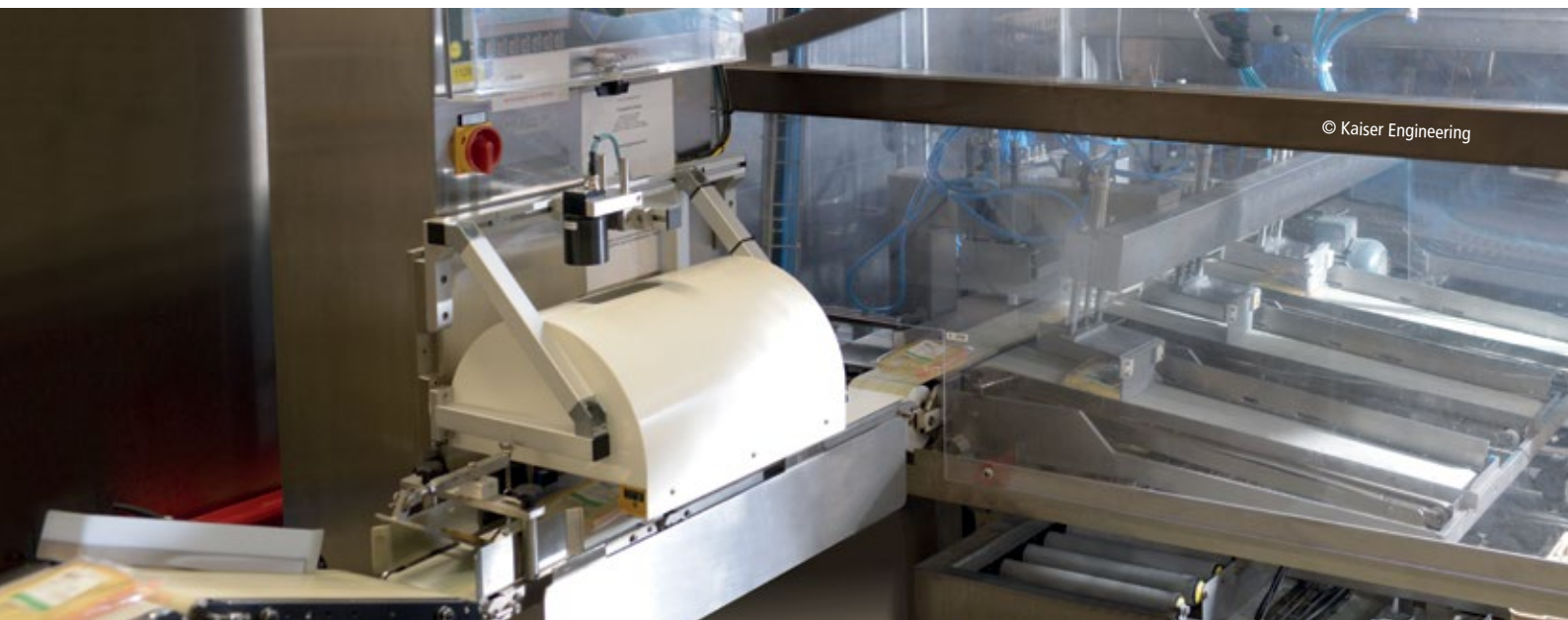
■ Abb. 1: Die Käseverpackungen laufen an dieser Station von links kommend unter dem Bildverarbeitungssystem hindurch und werden nach der Inspektion von einem Roboter in Transportkisten abgelegt.
