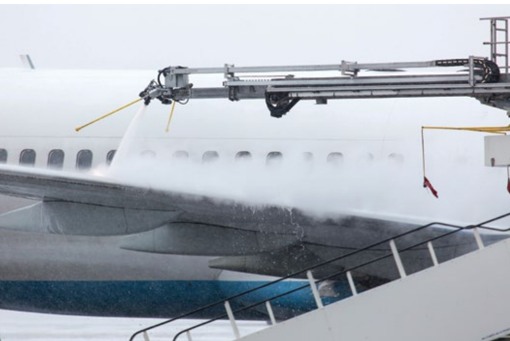
Abb. 1: JFK International Airport nutzt eine Nemo Exzentrerschneckenpumpe für seine Enteisungsanlage im Winterbetrieb. ▼
