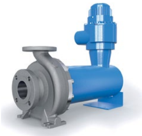
◀ Abb. 2: Der gekapselte und gänzlich leckagefreie Aufbau, bei dem sich der Motor im Inneren des druckfesten Statorgehäuses befindet, erlaubt eine dichtungsfreie Pumpenkonstruktion.
