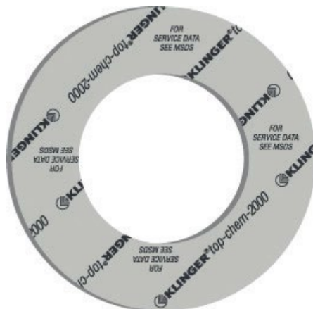
Abb. 3: Klinger topchem 2000 ist bei der Stahlerzeugung eine Alternative zu Graphitdichtungen, die hierbei auf Grund der Leitfähigkeit des Graphites nicht eingesetzt werden können.
