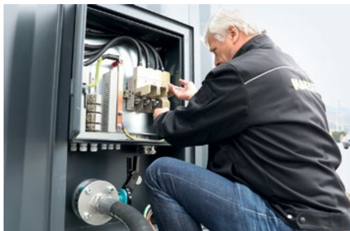
Abb. 2: Dank „Quick Connect“, einem leicht zu bedienenden Anschlussboard für Rohre und Kabel, kann er schnell und quasi an nahezu jedem Ort in Betrieb genommen werden.
