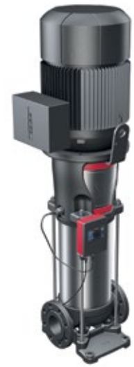
Abb.: Mit 16 Baugrößen (Förderstrombereich zwischen 0,3 und 355 m 3 /h), vier Werkstoffausführungen (Gusseisen, zwei korrosionsbeständige Edelstahlsorten, Titan) und einer Reihe unterschiedlicher Anschluss- und Ausstattungsvarianten steht dem Betreiber das wohl vielfältigste und umfassendste Pumpenprogramm auf dem Markt zur Verfügung.
