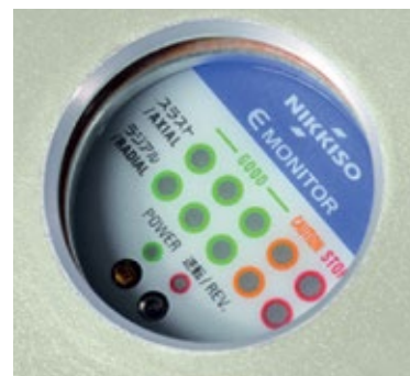
Abb. 3 a+b: Um die Verlässlichkeit und Betriebssicherheit zusätzlich zu verbessern, entwickelte Nikkiso den E-Monitor.
