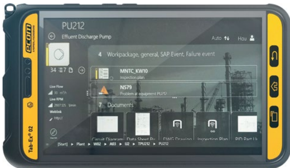
Abb. 2: Das Industrie-Tablet Tab-Ex 02 ermöglicht es Objekte einer Anlage zu identifizieren und Daten in Echtzeit auf das Display zu liefern.
