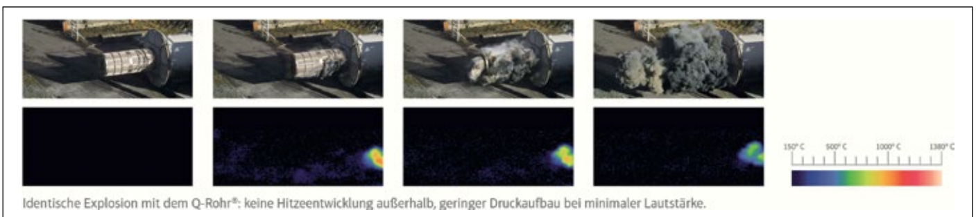
Abb. 9: Flammenlose Explosionsdruckentlastung durch das Q-Rohr
