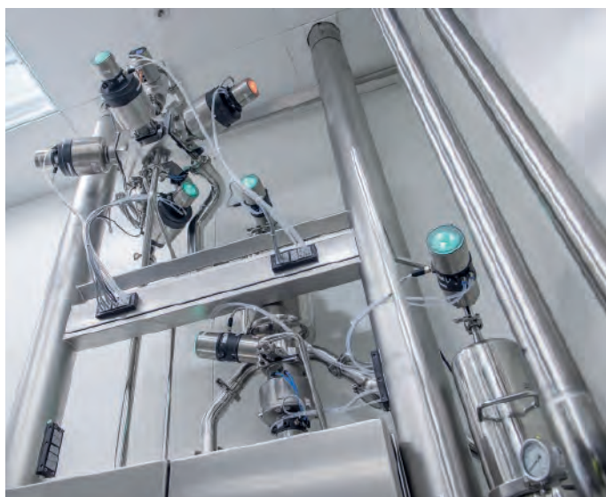
Abb. 2: Multiportventile und komplexe, multiportbasierte Verteiler der Robolux-Baureihe sparen rund 40 % Bauraum gegenüber herkömmlichen Ventilverteilern.
