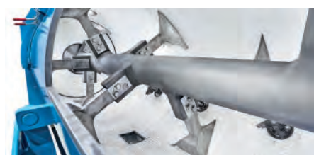
Abb. 2: Die Mischertrommel verfügt über eine keramische Auskleidung. Die Mischelemente, die Mischerwelle und die Messerköpfe werden mit einem dünnen, aber extrem festen keramischen Überzug versehen.
