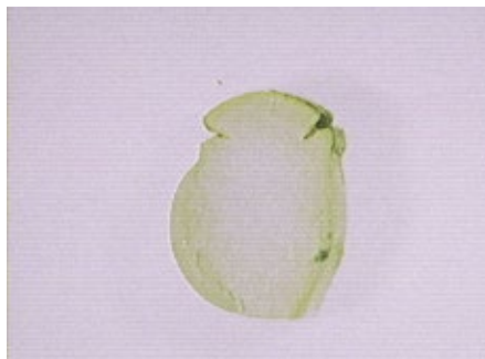
■ Abb. 2: Profilschnitt eines durch Quellung ausgefallenen O-Rings.
