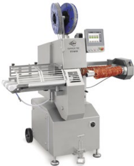
■ Abb. 2: Die modernen TT Doppelclip-Automaten im Hygienesdesign verschließen die Wurstportionen effizient und präzise. Sie werden auch für die Verpackung von Konditoreihalbfabrikaten, Käse, Suppen und Non-Food-Produkte eingesetzt.
