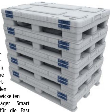
fige SLP hat das Europalettenmaß 1.200 x 800 mm und ist damit speziell auf den Lkw-Transport zugeschnitten. Es lassen sich in einem Lkw mit einer Ladehöhe von drei Metern 13 gefaltete SLP übereinander stapeln. Das erhöht die Fahrzeugauslastung, verringert die CO<sub>2</sub>-Belastung und senkt die Transportkosten.
