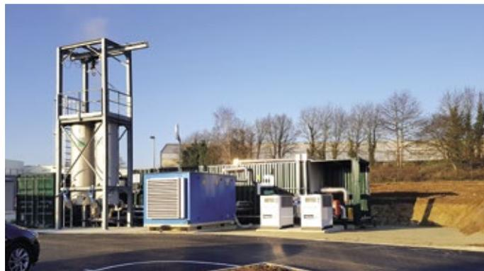
■ **Abb. 2:** Zur Konditionierung des Biogases zu Biomethan hat Weltec Biopower eine Membrantechnik als kompakte Containerlösung integriert.
