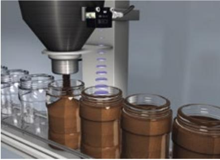
■ **Abb. 2:** Die Schallkeulenbreite der neuen Baumer Ultraschallsensoren lässt sich vor Ort in Abhängigkeit von Behälteröffnung und Füllmedium anpassen. Eine enge Schallkeule ist notwendig, wenn man einen Füllstand durch eine schmale Öffnung messen möchte.
