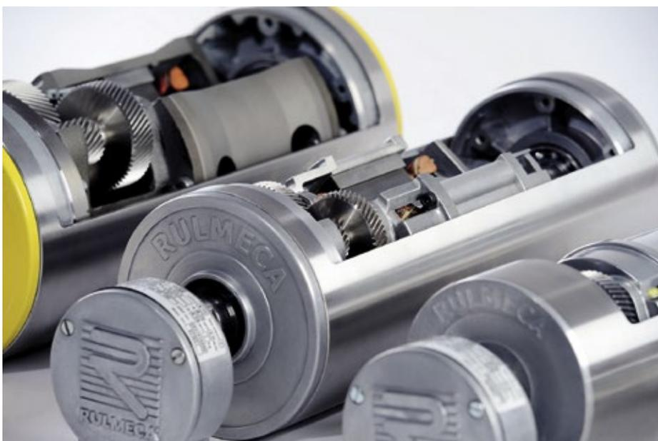
■ Abb. 1: Trommelmotoren als hermetisch geschützte All-in-One-Komponenten fertigt Rulmeca von 80 mm bis 1.000 mm Durchmesser. Bei Affeldt kommen sie von 113 mm Durchmesser und 370 W bis 320 mm Durchmesser und 7,5 kW zum Einsatz.
