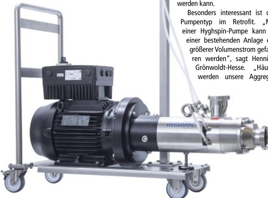
■ Abb. 3: Mobile Hyghspin-Einheit mit Pumpe, Steuerung und Transportwagen.
