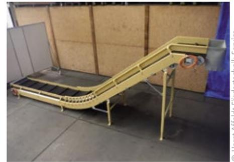
■ **Abb. 3:** Das Bogenförderband für schwere Lasten ist mit zwei Trommelmotoren von Rolmeca bestückt. Mit insgesamt 360° statt 180° Gurtumschlingung steht ein Drehmoment von knapp 200% zur Verfügung.
