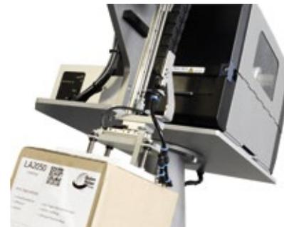
nimmt ein Applikator mit Spendestempel die fertigen Etiketten auf und appliziert sie auf das gestoppte Produkt. Ein Austausch des Stempels bei Formatwechsel ist nicht erforderlich, so dass auch keine Rüstzeiten anfallen. Rollenwechsel sind seltener erforderlich, was sich im Endeffekt auf die Produktivität auswirkt. Außerdem wird die Umwelt entlastet.
