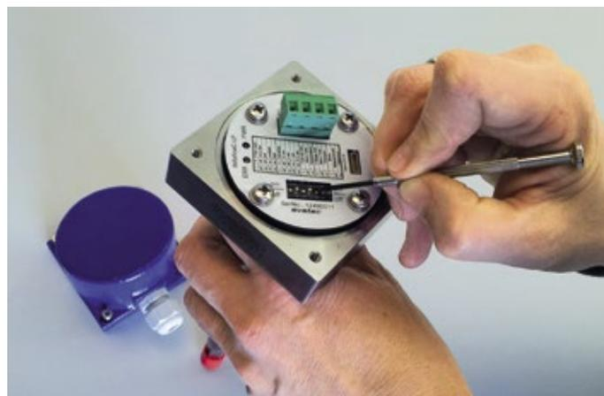
■ Abb. 2: Einfache Parametrierung mit DIP-Schaltern.
