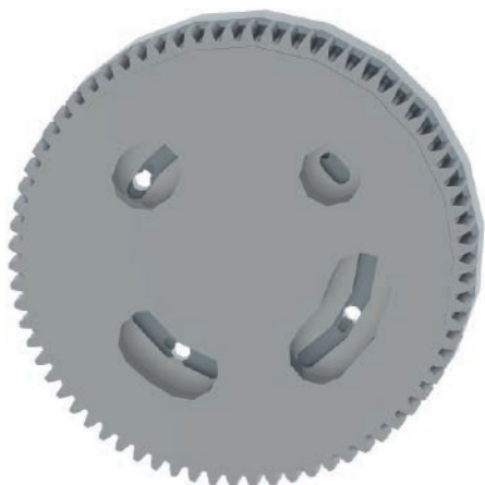
Abb. 2 Detailansicht der Dichtscheibe des Segmentplattenventils im Einspritzkühler
