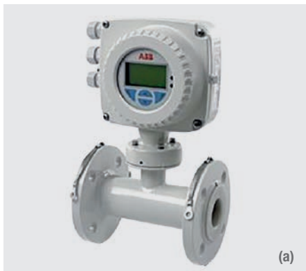
Abb.1: (a) Der elektromagnetische Durchflussmesser von ABB ist dargestellt. (b) Die Wechselwirkung des magnetischen Flusses mit dem sich bewegenden leitenden Fluid induziert ein elektrisches Potential ( \Phi_E ) proportional zur Strömungsgeschwindigkeit \Phi_1 - \Phi_2 .
