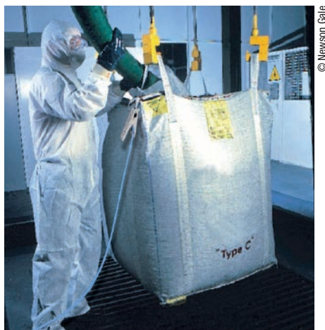
Abb. 2: Das Earth-Rite FIBC-System von Newson Gale validiert und überwacht den Widerstand von Typ C-Beuteln und stellt sicher, dass leitende Elemente in der Lage sind, Ladungen gemäß den Richtlinien abzuleiten.
