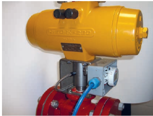
Abb. 1b: Beim Antrieb mit eingebauter TMK auf Kugelhahn ersetzt die Torsionsmesskupplung die herkömmliche Kupplung zwischen Antrieb und Armatur.
