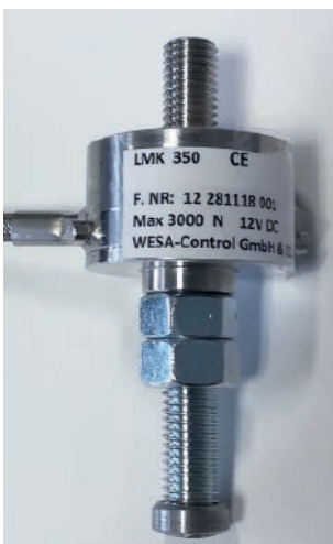
Abb. 3a: Die Linearmesskupplung LMK
