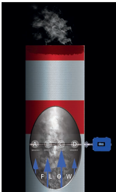
Abb. 2: An bis zu 4 im Sondenstab verbauten Messpunkten wird die Fließgeschwindigkeit an den neuralgischen Punkten im Rohr zu ermittelt.
