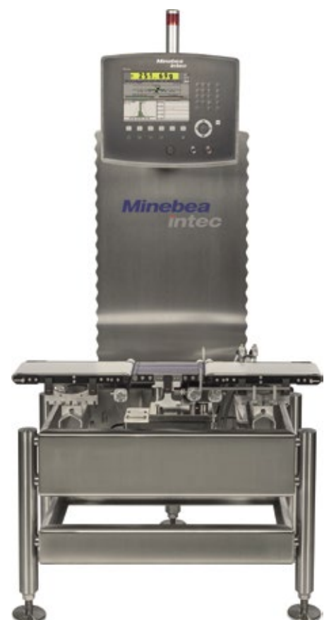
■ Abb. 2: Die Kontrollwaage Flex überprüft das Gewicht und die Vollständigkeit verpackter Lebensmittel und wurde ebenfalls nach den HygienicDesign-Richtlinien der EHEDG entwickelt.
