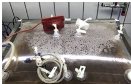
■ Abb. 2: Wellengemischter 20-Liter-Einweg-Bioreaktor.
