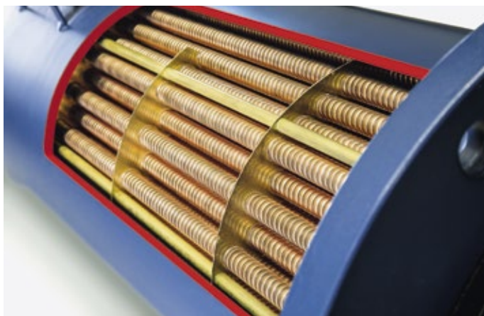
■ Abb. 2: Bei der Wärmerückgewinnung gilt es, den 85 % Anteil der thermischen Energie zu erschließen. Aerzen setzt dafür strömungsoptimierte Rohrbündelwärmetauscher ein, die kurz hinter dem Aggregat auf der Druckseite platziert sind.
