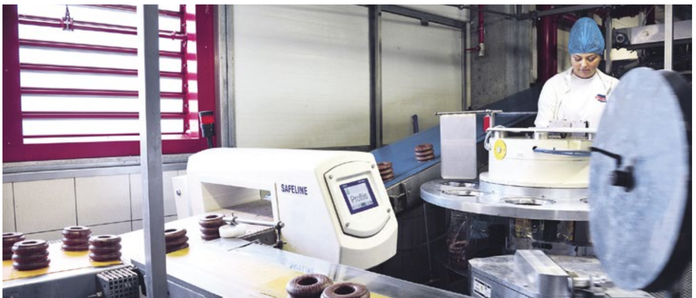
■ Abb. 1: Einsatz von Metallsuchtechnik zur Kontrolle homogener Produkte wie Tortenböden oder Hörnchen.
