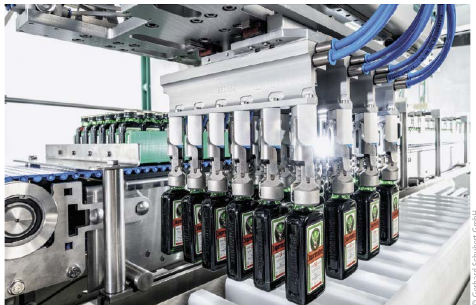
■ Abb. 3: Schnell und flexibel kann die neue TLM-Anlage die „Mini Meisters“ in 24er-, Neuner- und Zehner-Losgrößen verpacken.
