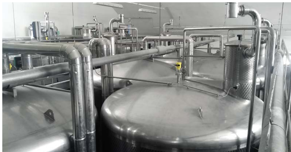
■ Abb. 3: Ein großer Vorteil des Vegapuls 64 ist die Bluetooth-Funktion, mit der sich der Sensor aus einer Entfernung von ca. 25 m drahtlos bedienen lässt.
