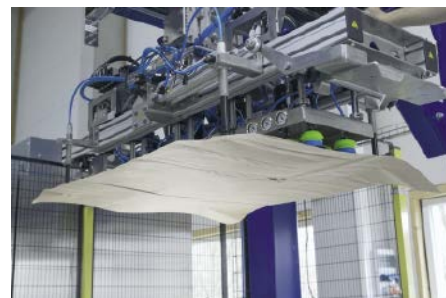
■ Abb. 2: Eine große Erleichterung für die Mitarbeiter ist die automatische Aufnahme und Platzierung der Papierzwischenlage.
