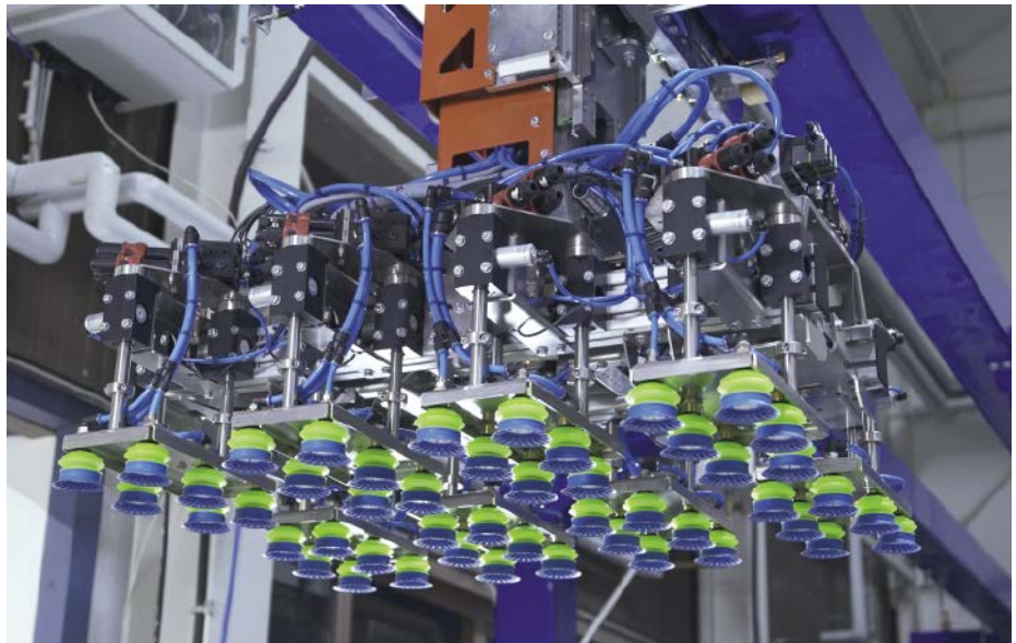
■ Abb. 3: Piab's konfigurierbare Pigrip Saugnapfe sind speziell dafür ausgelegt unebene Beutel und Vakuumverpackungen aufzunehmen.
