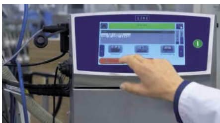
■ Abb. 2: Selbsterklärende Symbole leiten den Bediener durch das Menü des Continuous Inkjet-druckers Linx 8920. Produktionsparameter für bis zu 99 verschiedene Linien lassen sich hinterlegen und auf Knopfdruck aufrufen.
