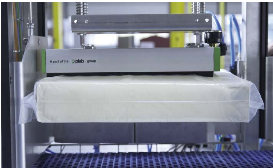
■ Abb. 1: Mit Piab's Kenos Flächengreifer wird die Vakuumverpackung geprüft. Wenn der Käseblock aufgenommen werden kann, kann das Lichtschrankensignal unter dem Käse durchleuchten und die Anlage sortiert den Käse zu der guten Charge.
