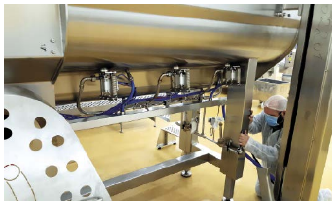
■ Abb.: Das System Lixshooter ermöglicht den Gaseintrag von unten und erzielt so eine direktere und schnellere Kühlwirkung als herkömmliche Verfahren, die das Kühlmittel von oben auf die Produktoberfläche aufbringen.
