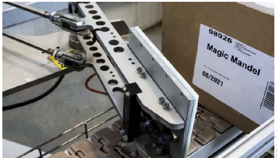
■ Abb. 3: Das Etikett wird auf der Vorderseite des vorbeifahrenden Kartons berührungslos appliziert.
