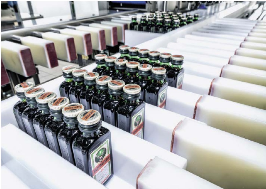
■ Abb. 2: Die flexible und auf das neue Verpackungskonzept angepasste TLM-Anlage ersetzt vollautomatisiert und präzise das bisherige Umpacken der kleinen Flaschen von Hand.
