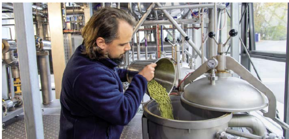
■ Abb. 3: Einziger manueller Eingriff im automatischen Sudhaus ist die Hopfengabe.
