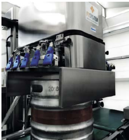
■ Abb. 1: Inline-Leckerkennung für Bierfässer. Das System basiert auf der innovativen Anwendung der optischen Spektroskopie.
