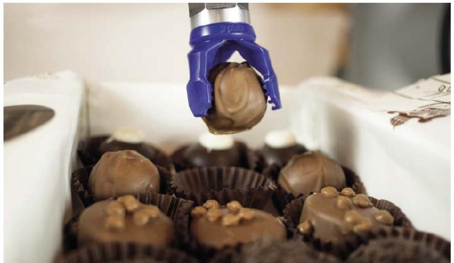
zeug ist so leicht zu steuern und zu installieren wie ein Saugnapf. Darüber hinaus lässt es sich auch leicht in Multimode-Anwendungen einsetzen, indem mehrere Pisoftgrip in Reihen oder verschiedenen Anordnungen eingesetzt werden. Es verwendet die gleichen Befestigungen wie die Pigrip Saugnapfe von Piab. Eine optionale Edelstahlbefestigung kann einfach abgewaschen und somit leicht gereinigt werden dank seiner intuitiven und benutzerfreundlichen
