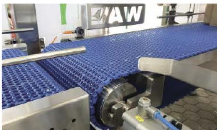
■ **Abb. 2: Butter-resistent: IP66/69plus geschützte Trommelmotoren von Rulmeca können bei Verschmutzung Clean-in-Place (CIP) mit Fettlösern und Hochdruck gereinigt werden.**
