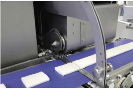
■ **Abb. 2:** Der Vemag Portionierer MMP223 portioniert Riegel, aber auch Blöcke und andere Formprodukte, außerordentlich formstabil und absolut gewichtsgenau bei geringstem Give-Away.
