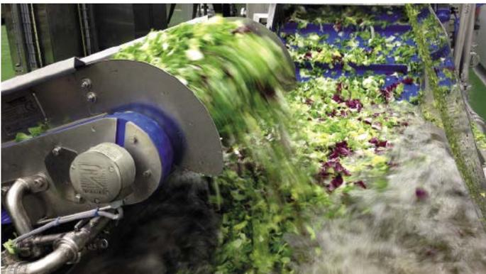
■ Abb. 1: Rulmeca Trommelmotoren erfüllen höchste Ansprüche an hygienisches Design durch eine hermetisch geschlossene all-in-one Konstruktion aus Edelstahl und TPE-Gurte und durch eine glatte, homogene und nicht poröse Oberfläche.
