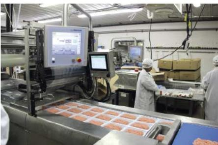
■ **Abb. 3:** Dank der Beratung und Expertise von Multivac wurde schließlich im März 2019 eine Tiefziehverpackungsmaschine des Typs R 245 bei Hayter's Farm installiert.
