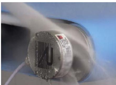
■ **Abb. 4: Das entscheidende Plus: Die von Rulmeca eingeführte Schutzart IP 66/69plus spezifiziert Schutz vor Hochdruckreinigern und Dampfstrahlern erstmals auch bei laufendem Betrieb und mit aufgespanntem Gurt, der seitlichen Druck auf die Dichtung ausübt. Schutzarten ohne Plus testen rein statisch und ohne Druckbelastung.**
