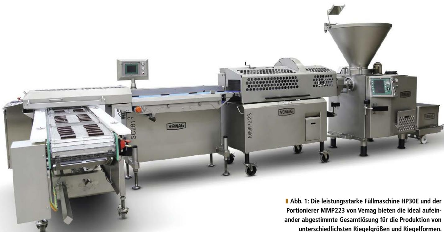
■ Abb. 1: Die leistungsstarke Füllmaschine HP30E und der Portionierer MMP223 von Vemag bieten die ideal aufeinander abgestimmte Gesamtlösung für die Produktion von unterschiedlichsten Riegelgrößen und Riegeformen.
