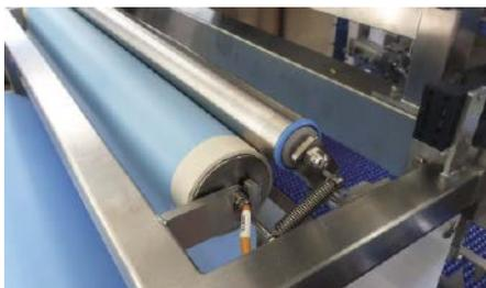
■ **Abb. 3: Weniger ist mehr: Rulmeca Trommelmotoren mit vollflächiger Gummierung zur Folienabwicklung reduzieren die Konstruktion auf das wesentliche – die Antriebsrolle.**
