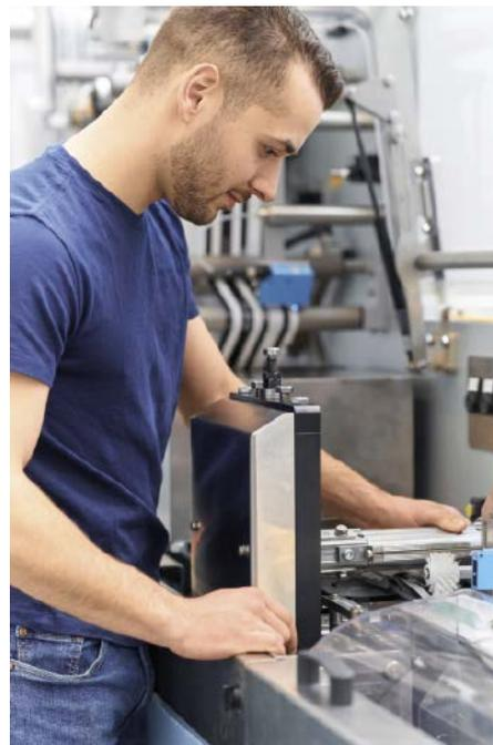
■ **Abb. 3:** Die Formeinheit „Paper-on-form“ von Syntegon formt Papierschlauchbeutel, ohne sie zu verknittern oder zu zerreißen.
