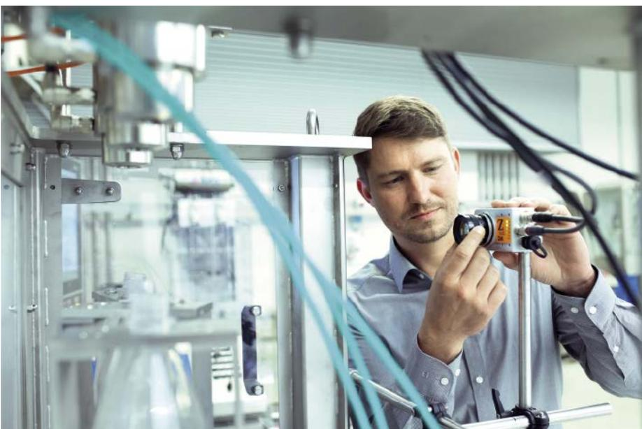
■ **Abb. 4:** Eine Kamera kontrolliert während des Füllprozesses Blaseneinschlag und Schaumbildung, wodurch Produktverluste vermieden werden können.
