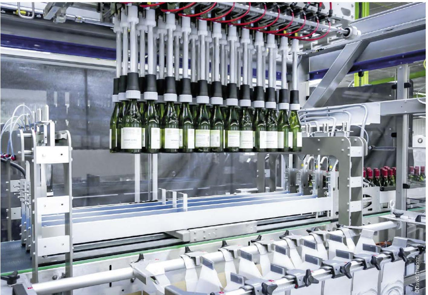
Abb. 1: Flexible Formatänderungen in nur zehn Minuten und ein modernes Produktflussmanagement sorgen für Flexibilität und Nutzerfreundlichkeit bei der Verpackung von Flaschen.
