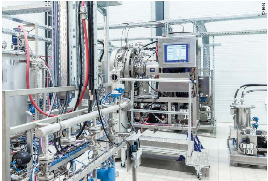
Abb. 3: Beispiel einer modularen Versuchsanlage mit Pilot-Druckdrehfilter bei BHS-Sonthofen.
