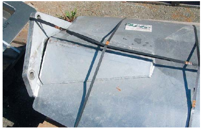
Abb. 3a+b: Schwingungsbrüche an Rührelementen durch Fehlkonstruktion.
