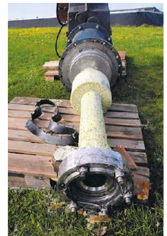
Abb. 2b: An der Kupplung gebrochene Rührerwelle.
