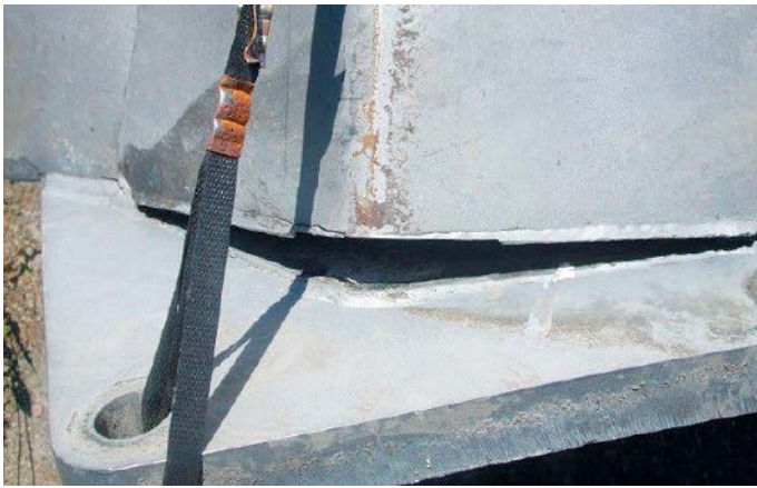
Abb. 3a+b: Schwingungsbrüche an Rührelementen durch Fehlkonstruktion.
