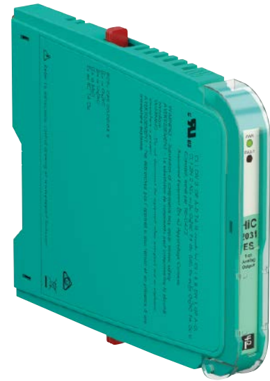
Abb. 2: Mit dem HIC2031ES zur Montage auf einem Termination Board können analoge SIL3-Signale aus dem explosionsgefährdeten Bereich sicher zu Steuerung übertragen werden.
