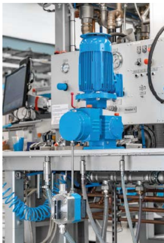
Abb. 1: Unabhängig von der Remote-Lösung wurde die integrierte Ecoflow-Variante genau auf die benötigte Propanmenge von 150 L/h abgestimmt.
