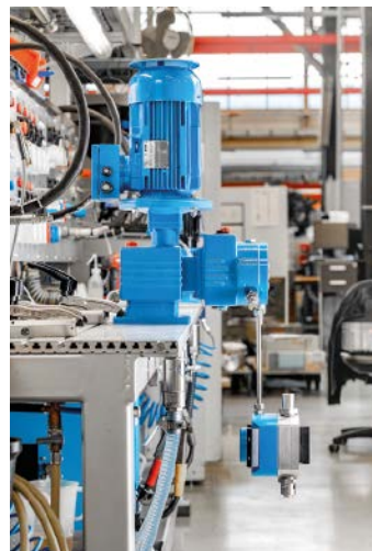
Abb. 2: Die hier verwendete Ecoflow-Variante ist auf 40 bar ausgelegt und kann somit das Propan mit ausreichendem Druck über die Einspritzdüsen an das Biomethan abgeben, sodass die Gasmischung im Ergebnis auch in Fernnetze eingespeist werden kann.
