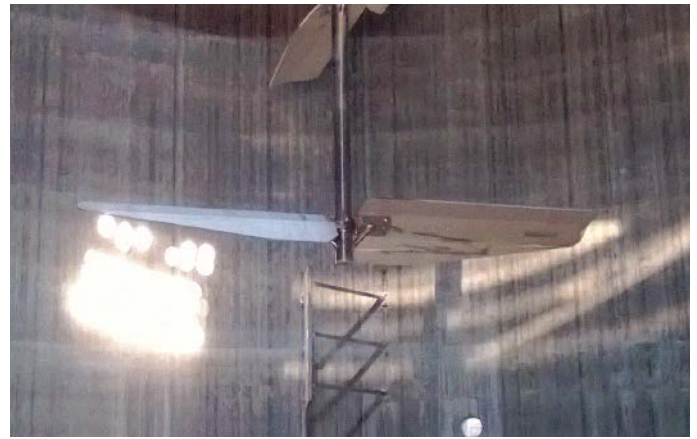
Abb. 1b: Flach angestelltes Rührerelement mit hoher Verzopfungsneigung und verminderter Förderwirkung.
