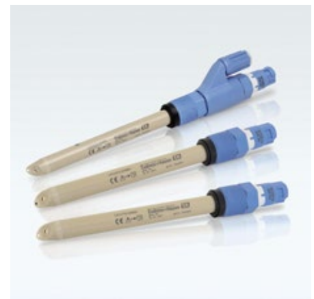
Abb. 3: Die neue Generation der ISFET-Sensoren (von oben nach unten): Memosens CPS47D mit Keramikdiaphragma und Flüssig-KCl-Referenz Memosens CPS97D mit Lochdiaphragma und gelgefüllter Referenz Memosens CPS77D mit Keramikdiaphragma und gelgefüllter Referenz
