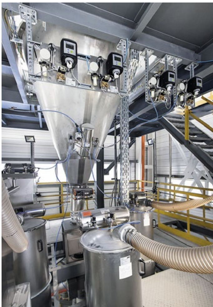
Abb. 2: Förderanlage unter Stickstoffschutzgasatmosphäre von AZO
