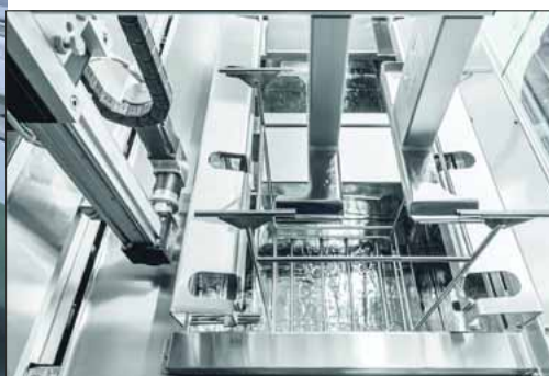
Der serienmäßige Transportautomat verfügt über einen Servoantrieb für einen sehr schonenden Werkstücktransport und teilespezifischen Lift-Out zur Vortrocknung aus dem letzten Spülbecken.
