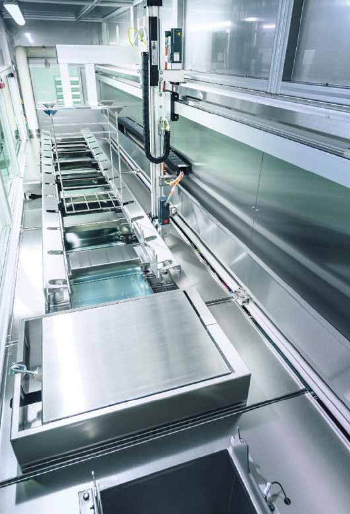
Die Anlagen können mit bis zu neun Reinigungs- und Spülstufen und variabel mit Mono-, Dual- und Multifrequenz-Ultraschall ausgestattet werden. © UCM
