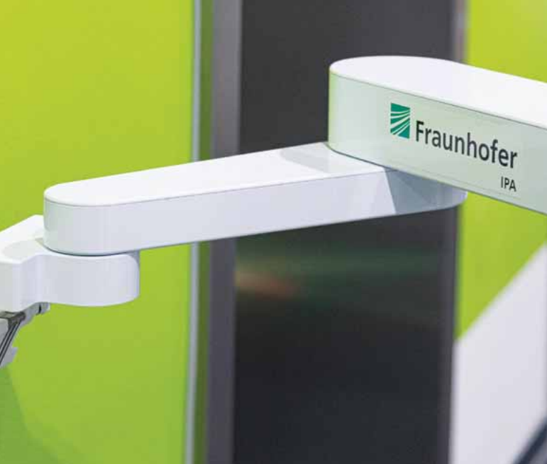
Abb. 2: Mithilfe seines flexiblen Reinigungswerkzeug kann DeKonBot eine Wischdesinfektion unterschiedlicher Objekte, bspw. auch von Aufzugknöpfen, durchführen.
