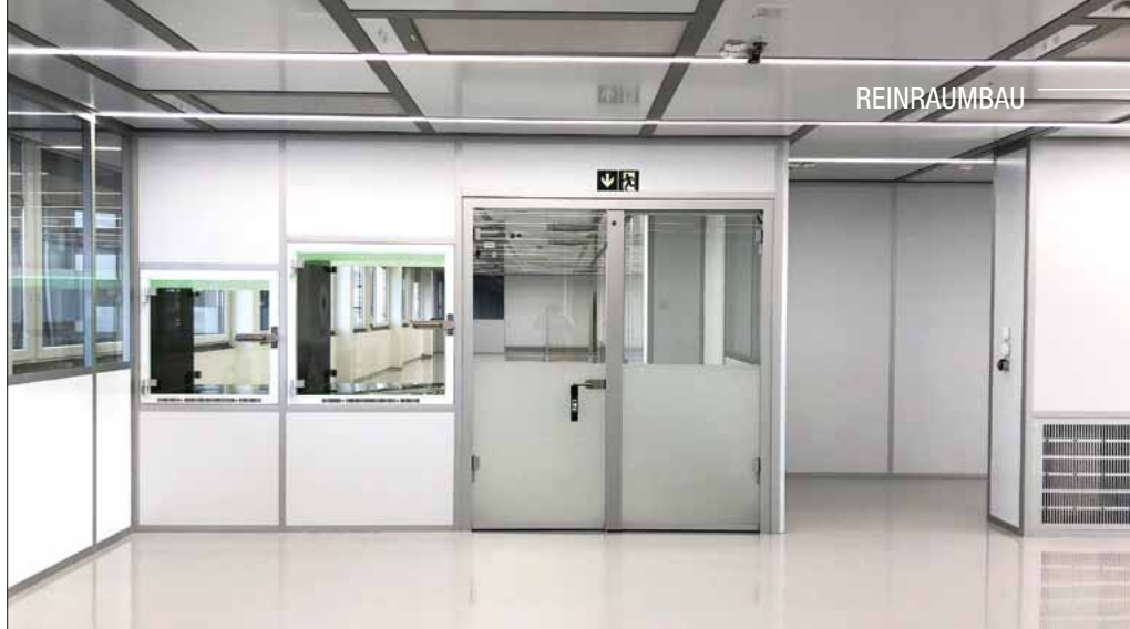
Abb. 2: Über mehrere farblich visualisierte Materialschleusen werden die Implantate sicher von der Reinraumzone ISO 7 in die Reinraumzone ISO 8 transportiert.
