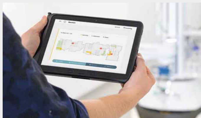
Abb. 3: Über eine intuitiv zu bedienende graphische Benutzeroberfläche wird die Einsatzumgebung eingelernt.
