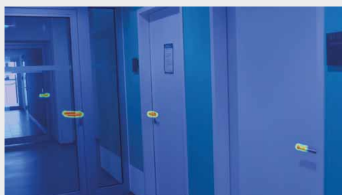
Abb. 4: Verfahren des maschinellen Lernens ermöglichen es, die zu reinigenden Objekte im Raum zu detektieren, hier am Beispiel von Türgriffen in einem Flur.
