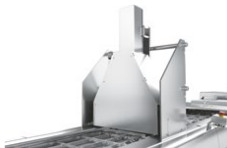
■ Abb. 3: Die leistungsfähige Inspektionslösung I 420 auf einer Tiefziehverpackungsmaschine überprüft die Kennzeichnung mittels Texterkennung oder Textverifizierung auf Lesbarkeit und Inhalt der Codes.
