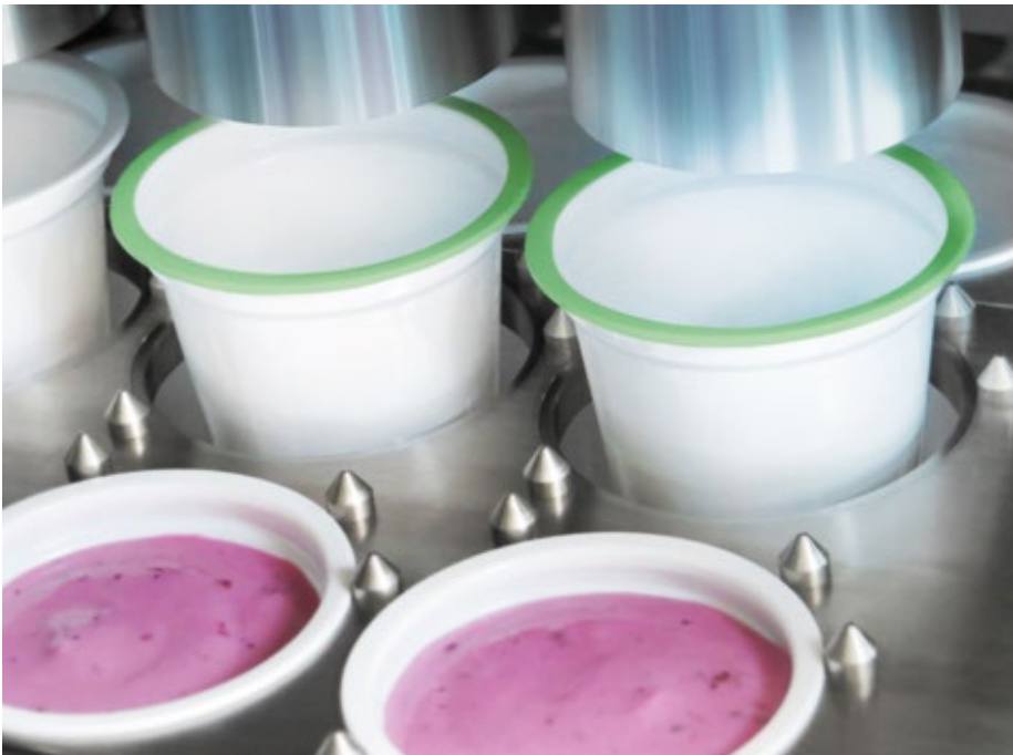
■ Abb. 2: Die volumetrischen Kolbendoseure der Ampack FCL von Syntegon Technology befüllen Becher mit 10 - 330 ml Inhalt.
