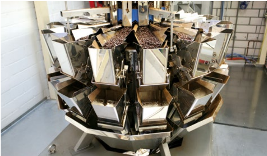
■ Abb. 2: Die Mehrkopfwage Ishida CCW-RVE wiegt die Kaffeebohnen mit höchster Genauigkeit: In Sekundenbruchteilen berechnet ein Mikroprozessor die Teilmengenkombination, die dem Zielgewicht am nächsten kommt.
