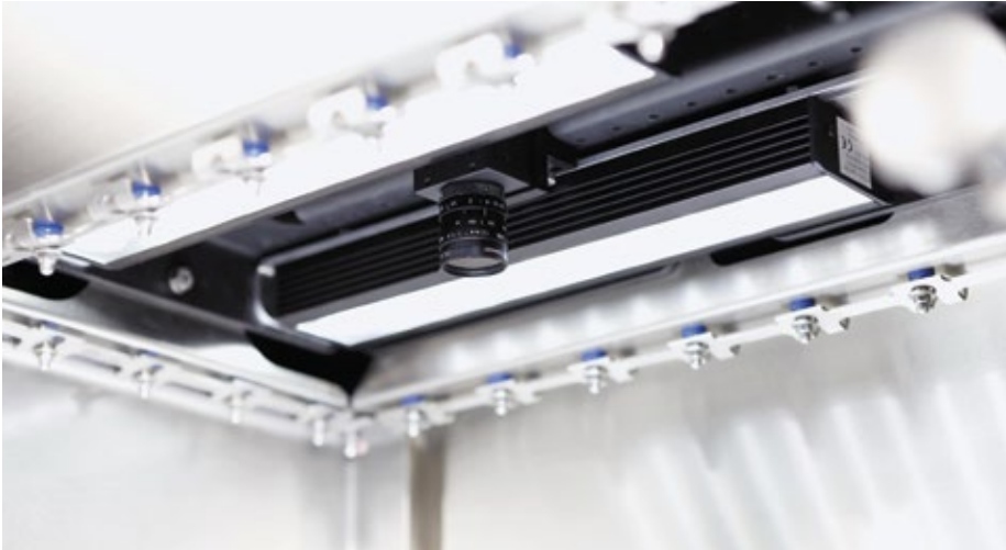
■ Abb. 2: Bei komplexen bzw. multifunktionalen Inspektionsaufgaben von der Text- und Mustererkennung bis hin zu einer umfassenden Bildanalyse sind PC-basierte Matrix- oder Zeilenkamerasysteme wie das Multivac MVS das Mittel der Wahl.
