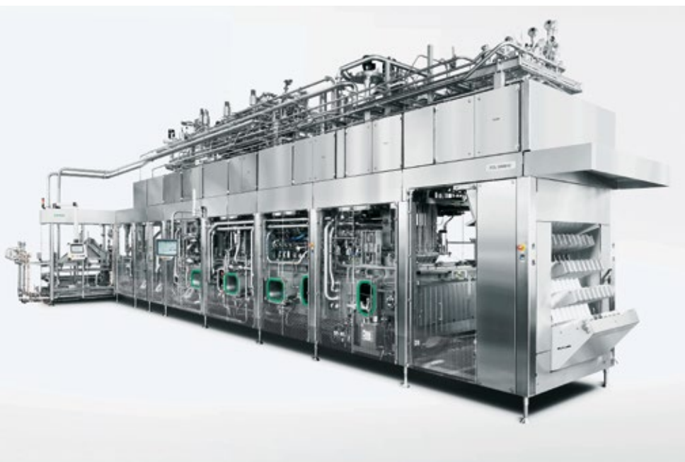
■ Abb. 1: Die Füll- und Verschließmaschine Ampack FCL von Syntegon Technology erweitert die Produktpalette an Joghurt- und Dessertprodukten bei Olma a.s.
