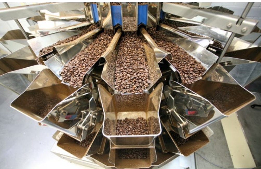
Abb. 1: Über die einzeln ansteuerbaren Radialrinnen der Mehrkopfwaage Ishida CCW-RVE gelangen die Kaffeebohnen gleichmäßig zu den Vorschalen der Waage.
