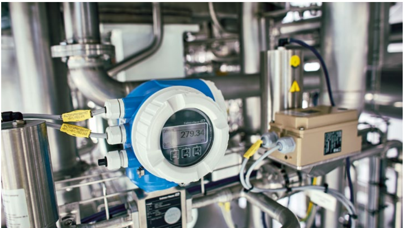
■ Abb.: Smarte Sensoren sind der Schlüssel zur Digitalisierung: Durchflusssensoren der Proline 300/500-Familie besitzen einen integrierten Webserver und WLAN sowie Selbstdiagnosesysteme.
