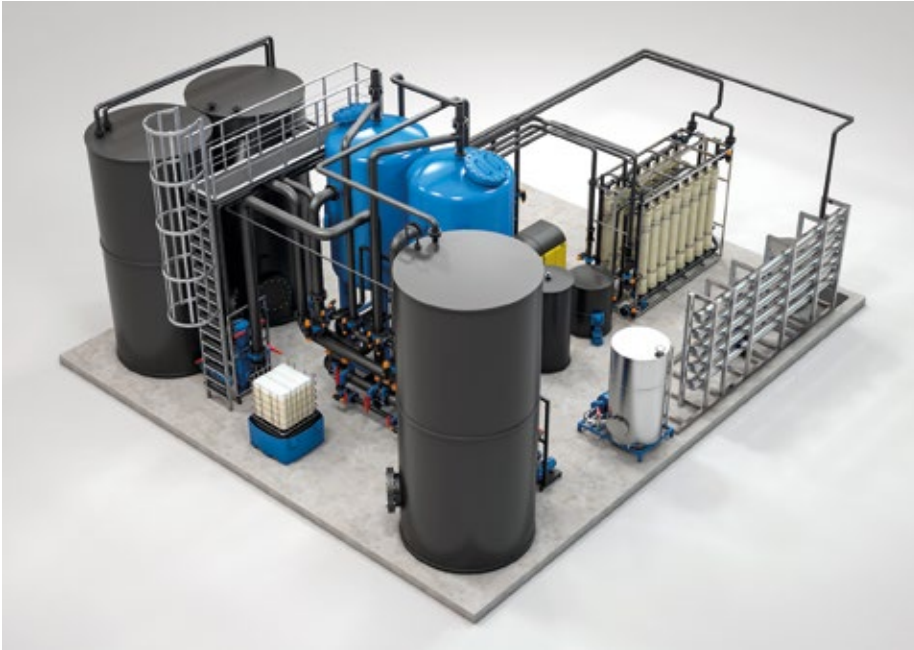
■ Abb. 2: Modell einer Büdenwasseraufbereitungsanlage, mit der wertvolles Frischwasser ersetzt werden kann.
