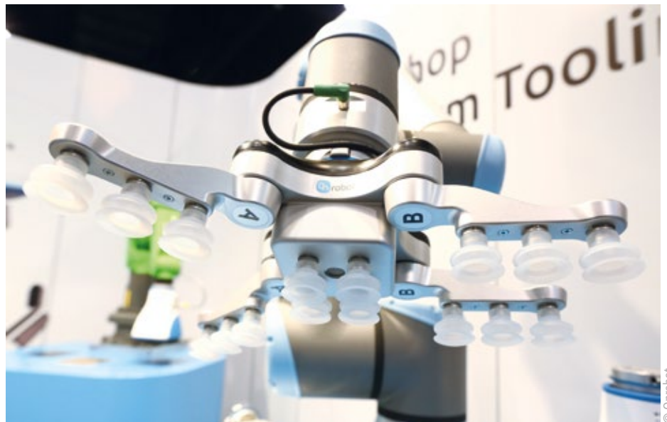
Abb. 2: Auch Vakuumbreifer wie bspw. der VG10 von Onrobot eignen sich ideal für Aufgaben im Bereich Verpackung und Palettierung.
