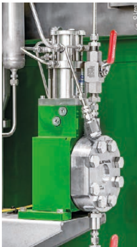
Abb. 2: Mit der PKH Druckluftpumpe wurde ein rein pneumatisches Aggregat verbaut, das für einen vor Ort benötigten Gasstrom von 500 m 3 pro Stunde bei 30 bar ausgelegt ist.
