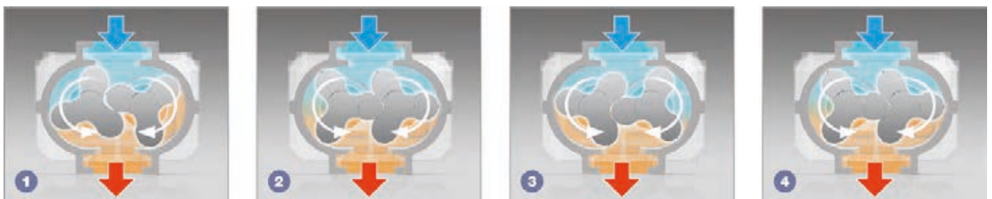
Abb. 2: Querschnitt eines Drehkolbengebläses und der Ablauf der Verdichtung, die darin erfolgt.
