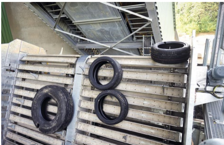
Abb. 2: Der Hakenvereinzeler verhindert, dass Reifen beim Transport übereinanderliegen.
