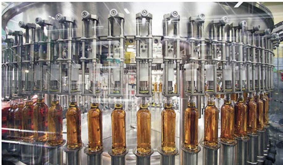
Abb. 4: MBF sucht immer wieder nach neuen Lösungen, wie der Abfüllzyklus weiter optimiert werden kann. Dies beinhaltet spezielle Lösungen, die Verdunstung, Turbulenzen und Rückführung des Produkts verhindern. Nur so stimmen Alkoholgehalt und Aroma.
