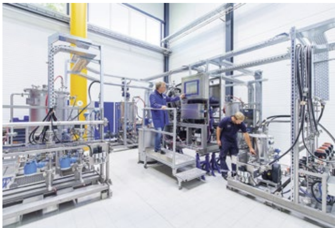
Abb. 1: Im hauseigenen Test Center hat BHS-Sonthofen eine modulare Versuchsanlage mit Pilot-Druckdrehfilter installiert.
