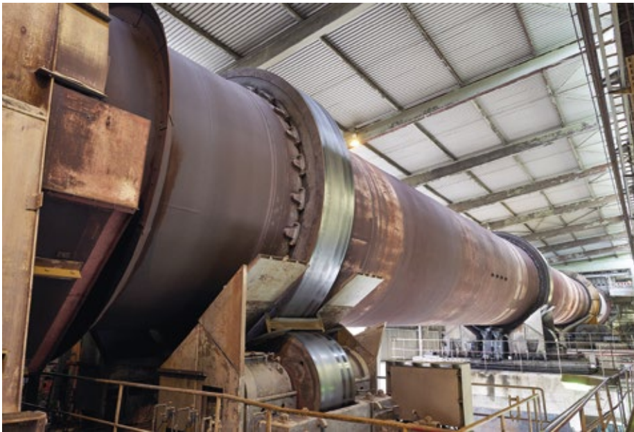
Abb. 5: Mit rund 700 Reifen in der Stunde kann der Drehrohrföfen beschickt werden.
