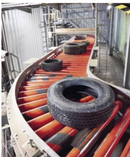
Abb. 3: Ein Reifen nach dem anderen. Auf der Rollenbahn gelangen die Reifen geführt zu den einzelnen Stationen..
