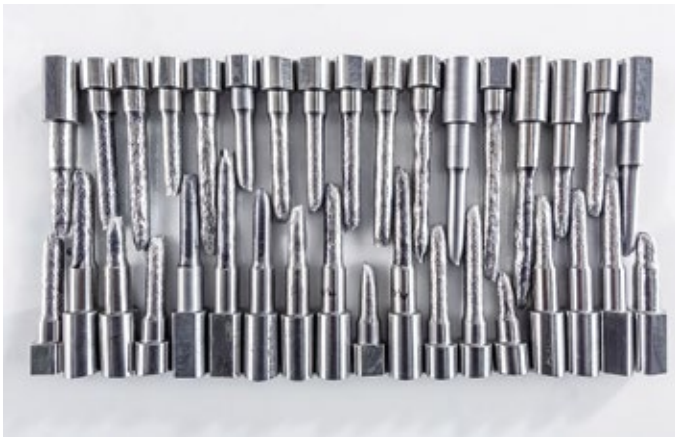
Abb. 3: Proben für den Zugversuch dienen der Ermittlung von Werkstoffkennwerten (z.B. Zugfestigkeit, Bruchdehnung und Streckgrenze). Die Proben werden in einer Zugprüfmaschine mit einer definierten Kraft bis zum Bruch auseinandergezogen.
