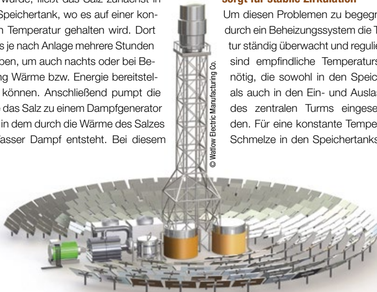
Abb. 2: Bei einer CSP-Anlage wird das Sonnenlicht von Spiegeln auf einen zentralen Turm hin gebündelt, der das Licht absorbiert und damit die Wärme an einen flüssigen Energieträger im Inneren des Turms weitergibt.
