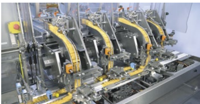
■ Abb. 3: Die motorisierten Magazine transportieren die Cracker zügig auf ein zweispuriges Band.
