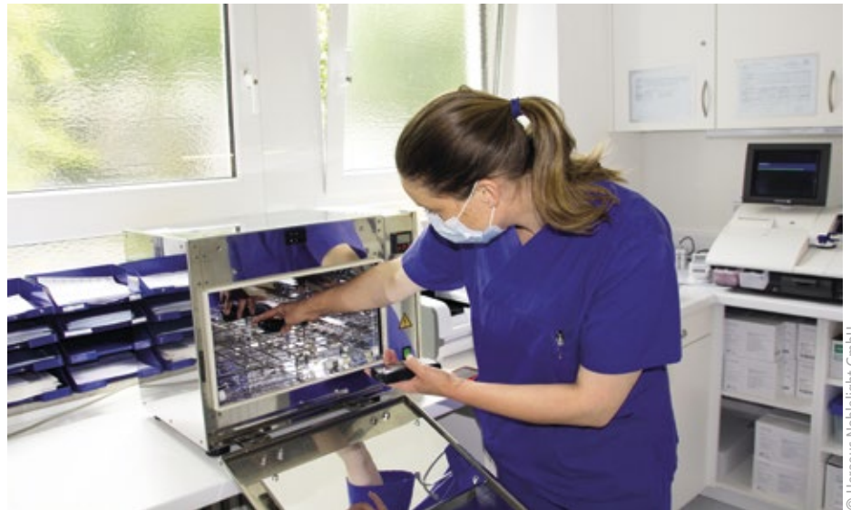
■ Abb. 2: Die Soluva UV Disinfection Chamber verwendet UVC-Lampen und hochreflektierendes Aluminium, um Objektflächen vollständig in UVC-Licht zu „baden“. So werden Viren und Mikroorganismen effektiv abgetötet.
