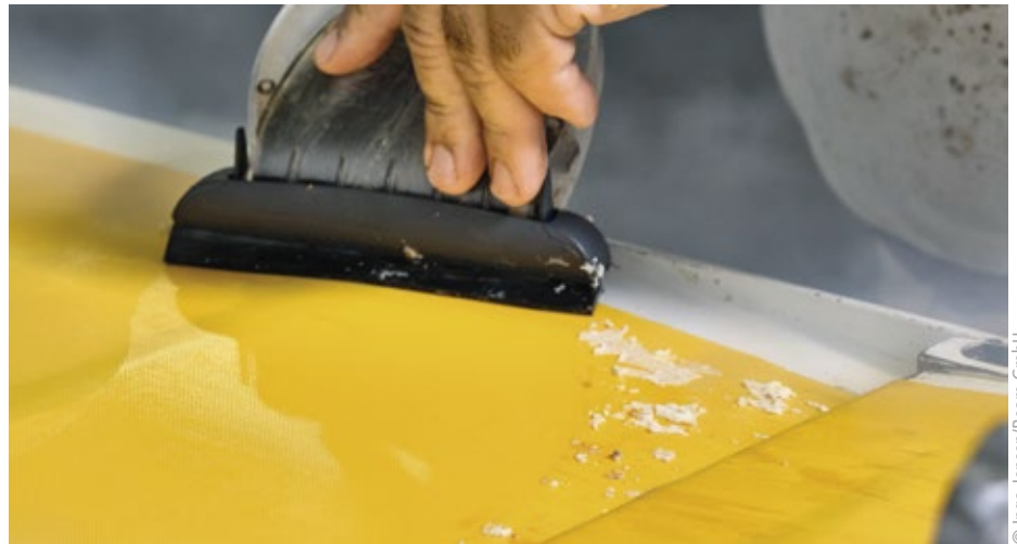
■ Abb. 2: Die Handdüse mit Gummilippe sorgt für eine perfekte Reinigung der Förderbänder.
