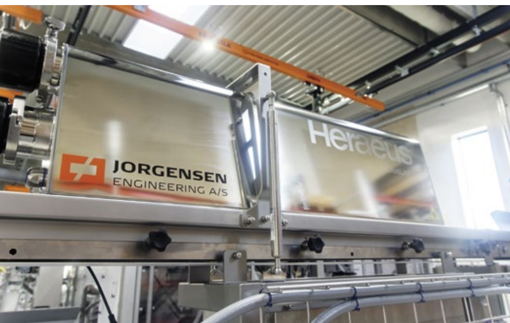
■ Abb. 1: Das neue UV-System von Heraeus Noblelight reduzierte bei Jorgensen Engineering den Platzbedarf für die Desinfektion um 60 %.
