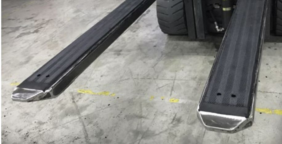
■ Abb. 2: Auch die abgebildete Beschichtung mit Grippfix ist vor Ort möglich.
