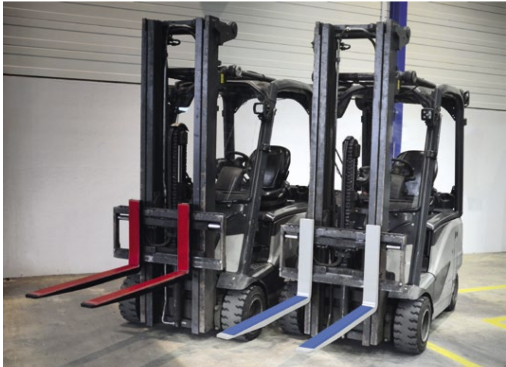
■ Abb. 1: Verkratzte oder beschädigte Oberflächen bei empfindlichen Ladegütern sind ein Risiko und verursachen Transportlärm. Viele Staplernutzer setzen daher auf die Beschichtung von Gabelzinken mit Polyurethan, Gummi oder Grippfix.
